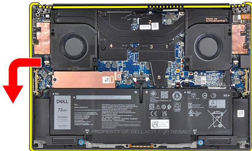
**i N.B.:** Il gruppo del display è di tipo Hinge-Up Design (HUD) e non può essere ulteriormente smontato una volta rimosso dalla parte inferiore dello chassis. Se uno dei componenti nel gruppo del display è guasto e deve essere sostituito, sostituire l'intero gruppo.
