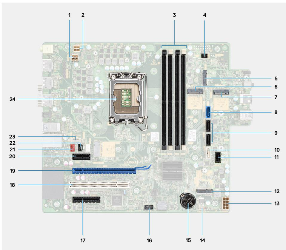
1. Connettore di alimentazione CPU ATX
