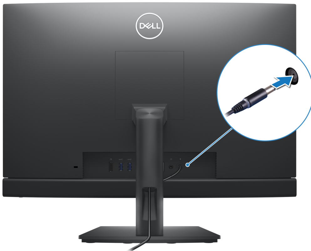
Figura 12. Collegamento del cavo dell'adattatore per l'alimentazione
