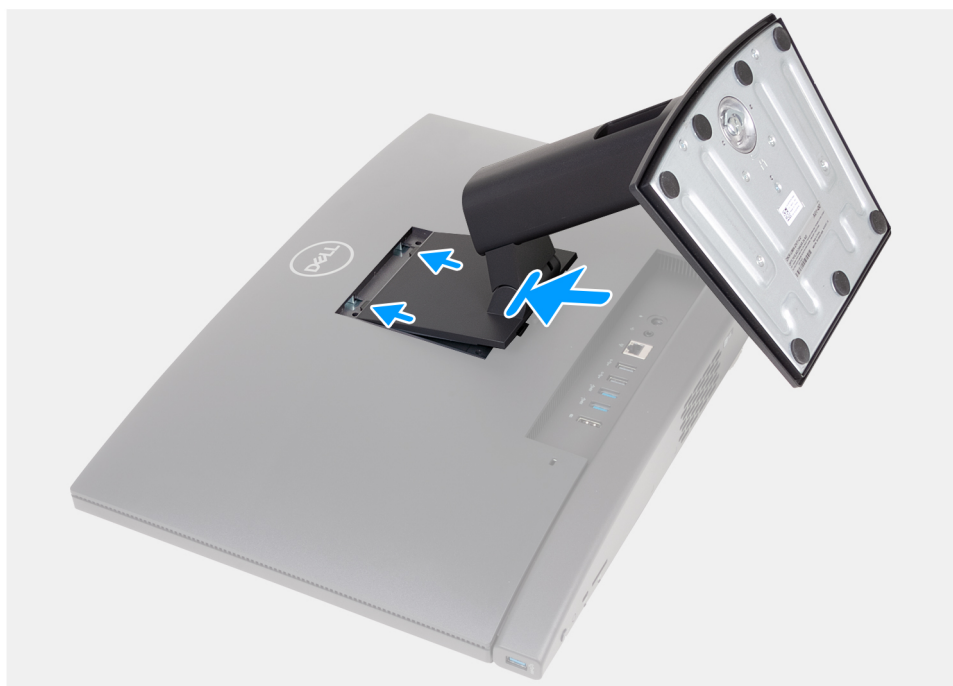
Figura 80. installazione del supporto
