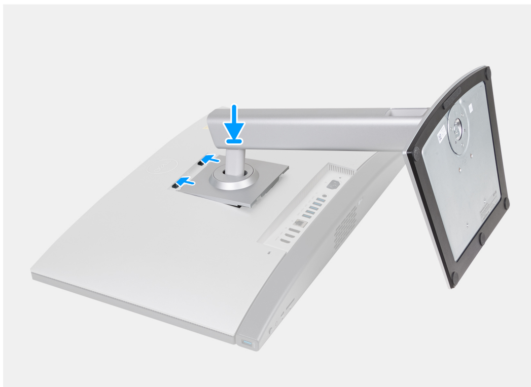
Figura 20. Installazione del supporto ad altezza regolabile (HAS)
