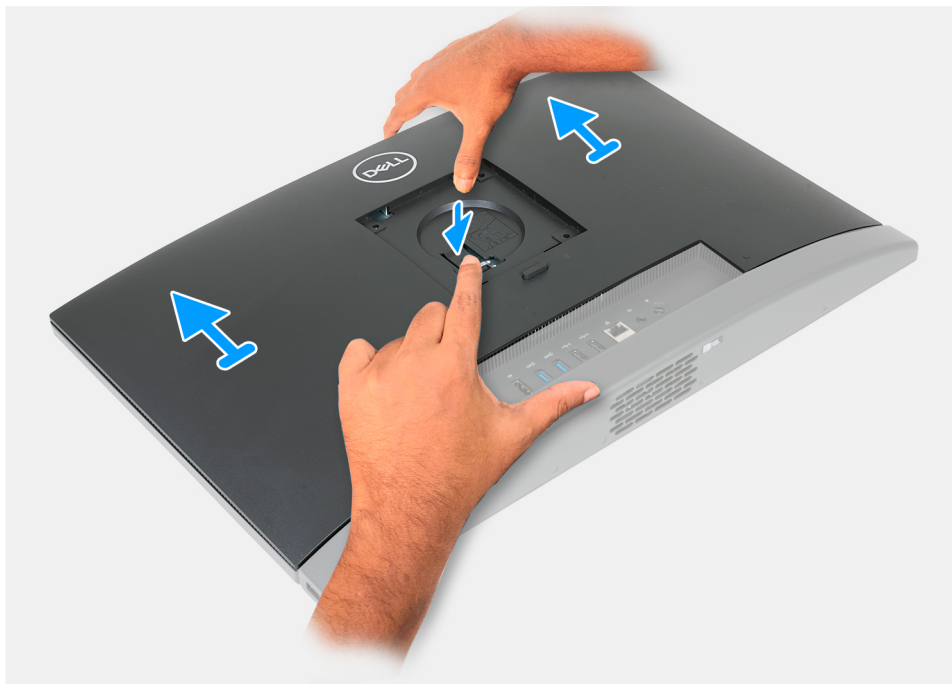
Figura 82. Rimozione del coperchio posteriore
