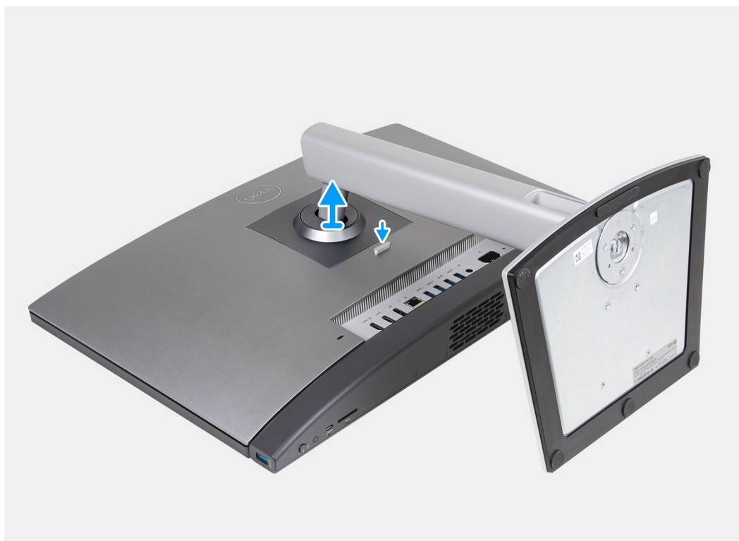
Figura 79. Rimozione del supporto
