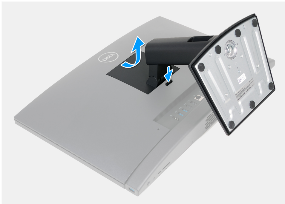
Figura 78. Rimozione del supporto
