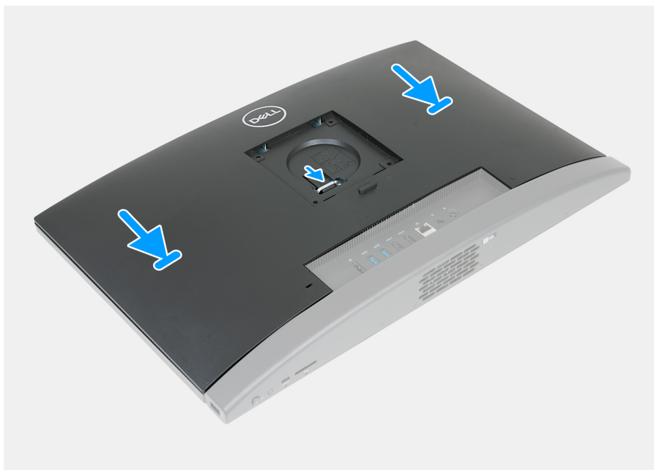
Figura 83. Installazione del coperchio posteriore
