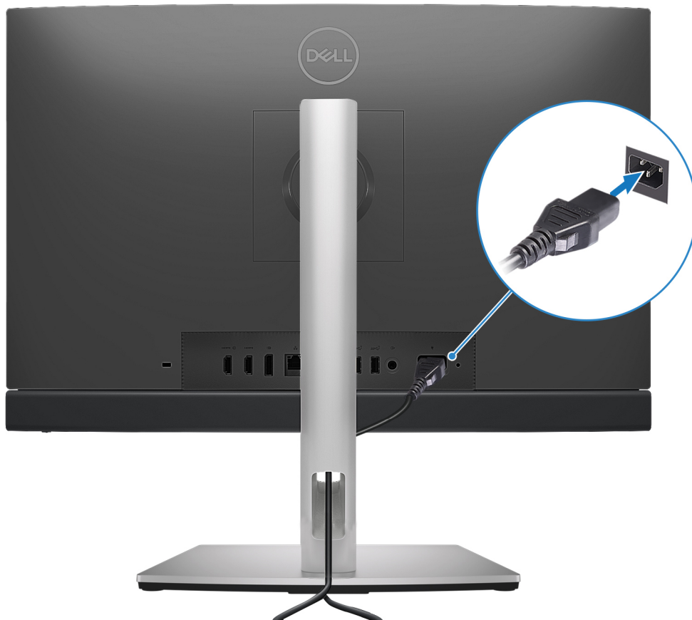
Figura 13. Collegamento del cavo di alimentazione
