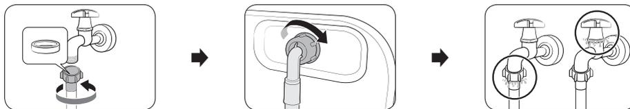
1. Collegare il tubo al rubinetto dell'acqua quindi ruotare il connettore per serrarlo.
