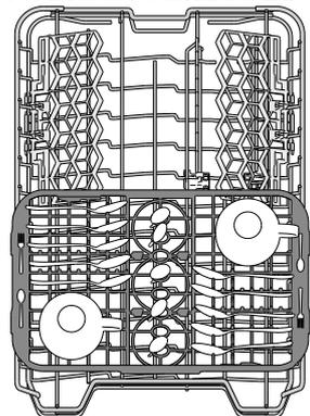
Il cestello superiore è munito di piano scorrevole adatto ad alloggiare stoviglie di piccole dimensioni e posate. Per ottimizzare le prestazioni di lavaggio, evitare di sistemare posate di dimensioni ingombranti direttamente in corrispondenza del punto sottostante al piano scorrevole. Il piano scorrevole è rimovibile.
