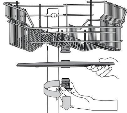
Per smontare il braccio aspersore superiore, ruotare l'anello di bloccaggio in plastica in senso antiorario. Il rimontaggio del braccio aspersore deve avvenire in modo che il lato con il maggior numero di fori sia rivolto verso l'alto.
