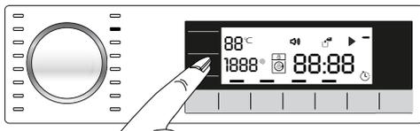
Premere di nuovo il pulsante di **regolazione della velocità di centrifuga** per cambiare la velocità di centrifuga. La velocità di centrifuga diminuisce in modo graduale.
