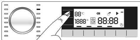
Premere di nuovo il pulsante di **regolazione della temperatura** per cambiare la temperatura. La temperatura diminuisce a incrementi di 10 °C.
