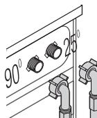
Collegare i flessibili speciali di alimentazione dell'acqua forniti con prodotto alle valvole di ingresso dell'acqua sull'elettrodomestico. Il flessibile rosso (sinistra) (max. 90 °C) è per l'ingresso dell'acqua calda, il flessibile blu (destra) (max. 25 °C) è per l'ingresso dell'acqua fredda.
