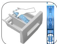
Pulire il cassetto del detersivo ad intervalli regolari (ogni 4-5 cicli di lavaggio) come mostrato di seguito per evitare l'accumulo di polvere di detersivo nel tempo.
