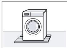
Collocare l'apparecchio su una base di legno resistente all'acqua (spessore minimo di 30 mm) ben fissata al pavimento.
