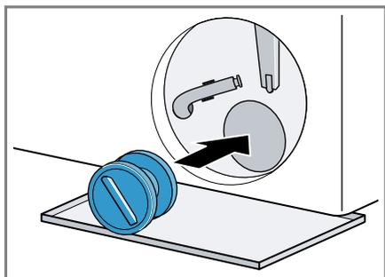
3. Chiudere il coperchio della pompa ruotandolo finché non si innesta.
