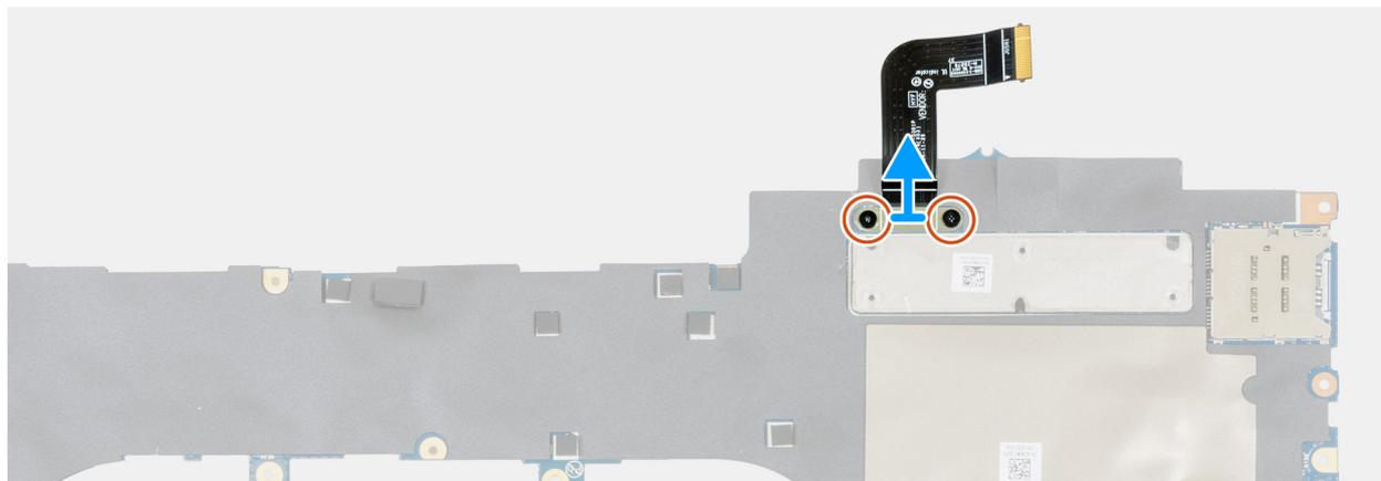
**Figura 117. Rimozione del cavo della scheda USH**
