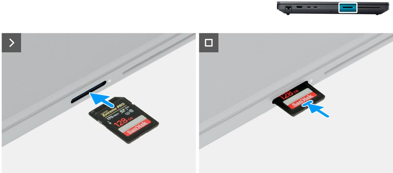
Figura 11. Installazione della scheda SD
