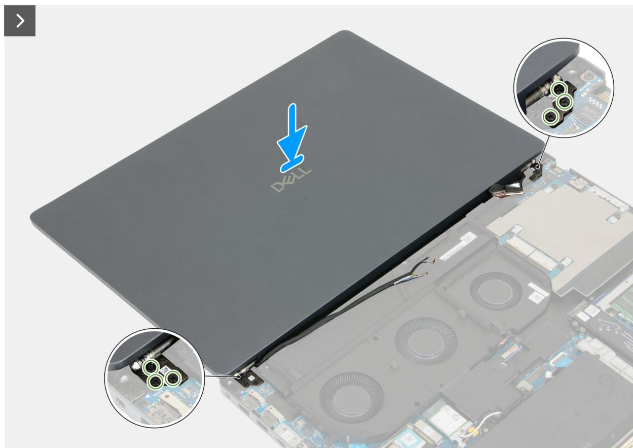
Figura 65. Installazione del gruppo del display
