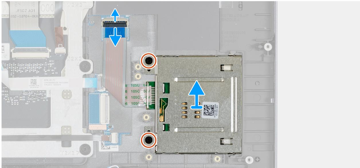
**Figura 123. Rimozione del lettore di smart card**
