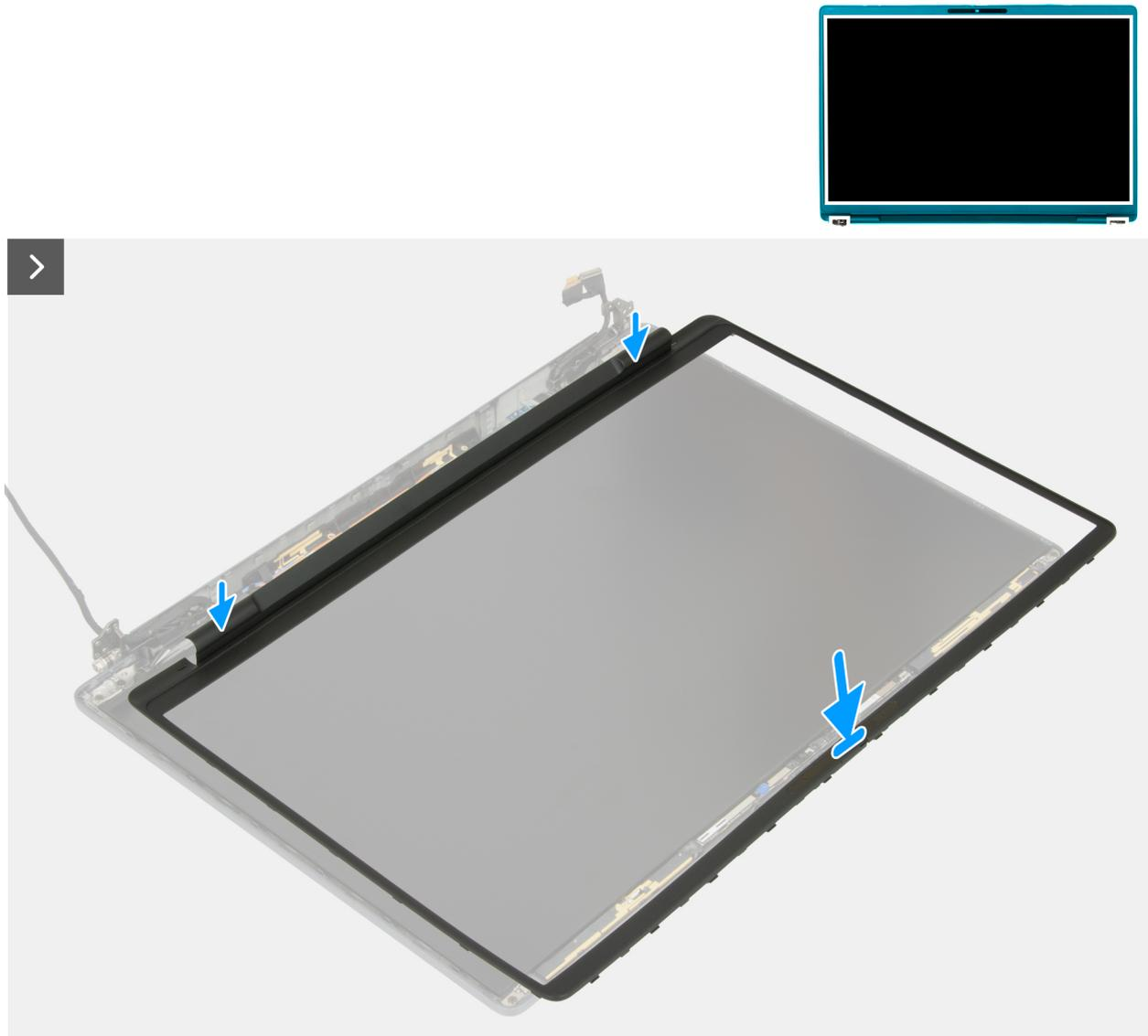
Figura 89. Installazione della cornice del display
