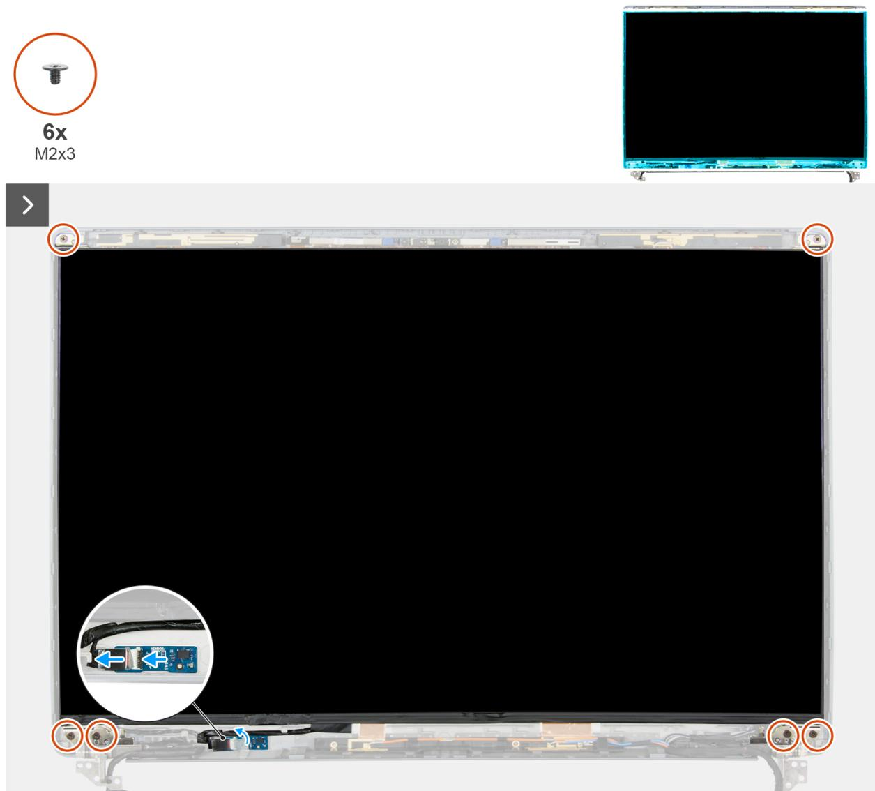
**Figura 95. Rimozione del pannello del display**
