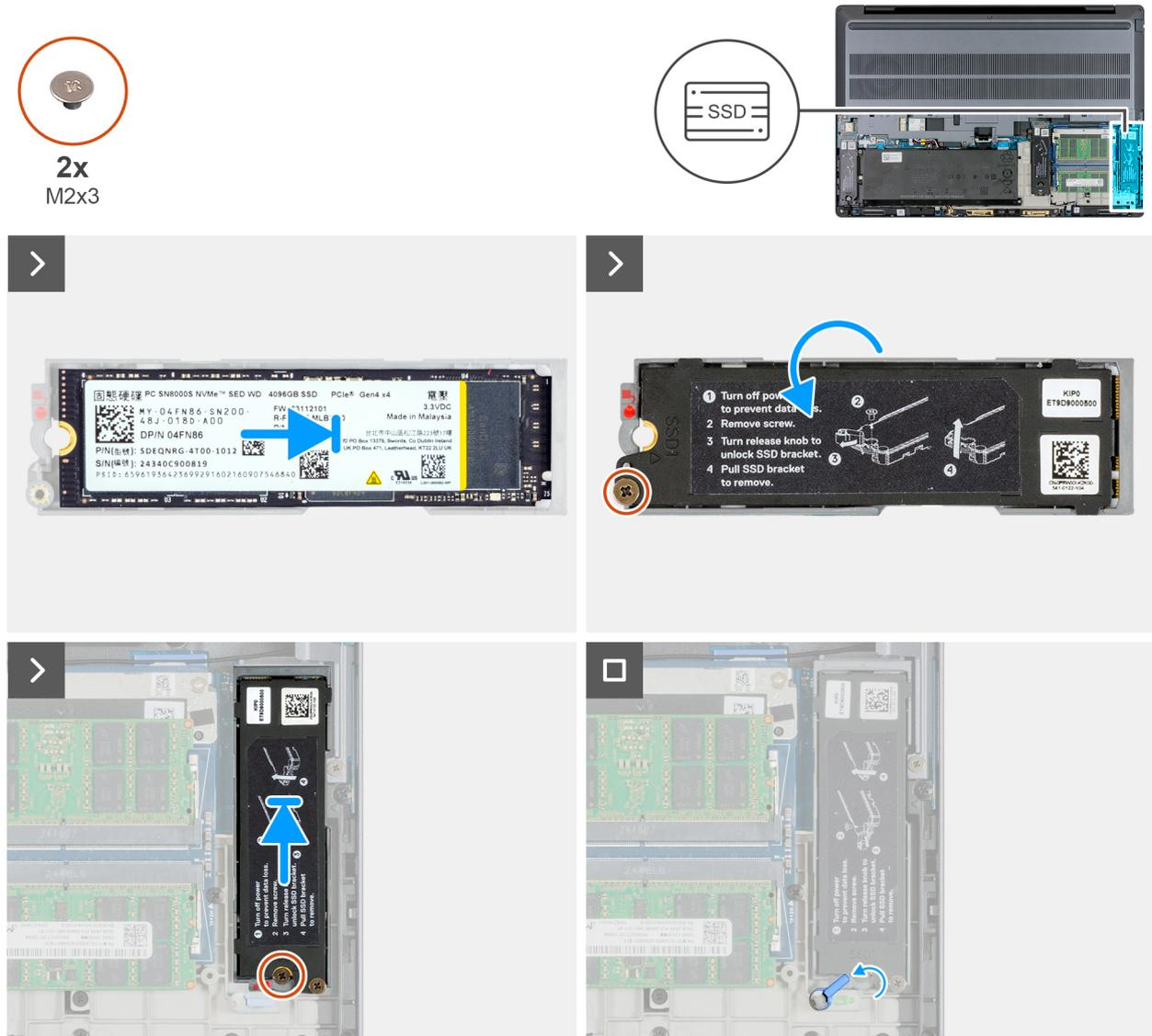
**Figura 35. Installazione dell'SSD M.2 2280 nello slot 1 (SSD1)**
