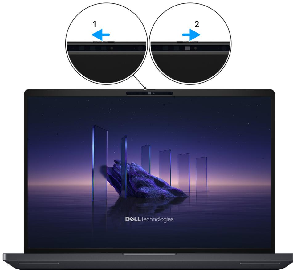
**Figura 8. Otturatore fotocamera**
