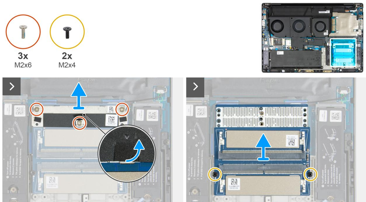
**Figura 67. Rimozione della scheda interposer della memoria**
