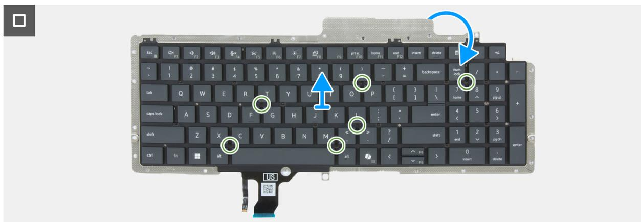
Figura 120. Rimozione della tastiera
