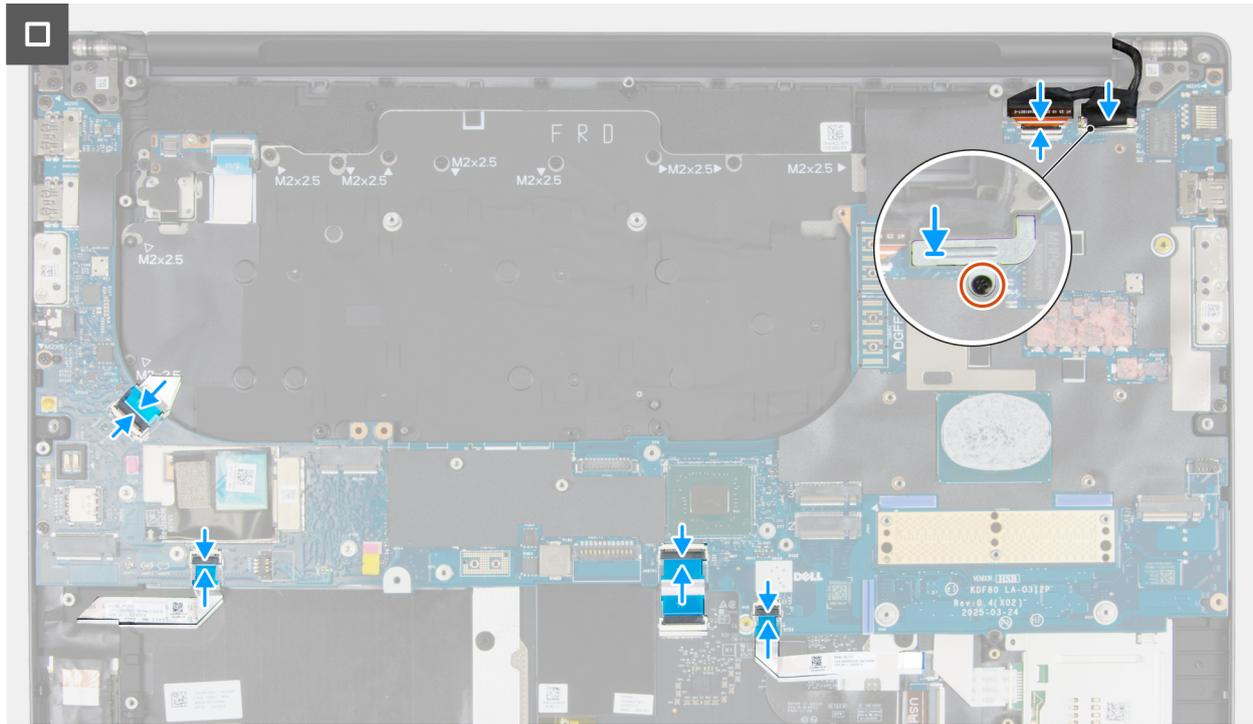
**Figura 114. Installazione della scheda di sistema**
