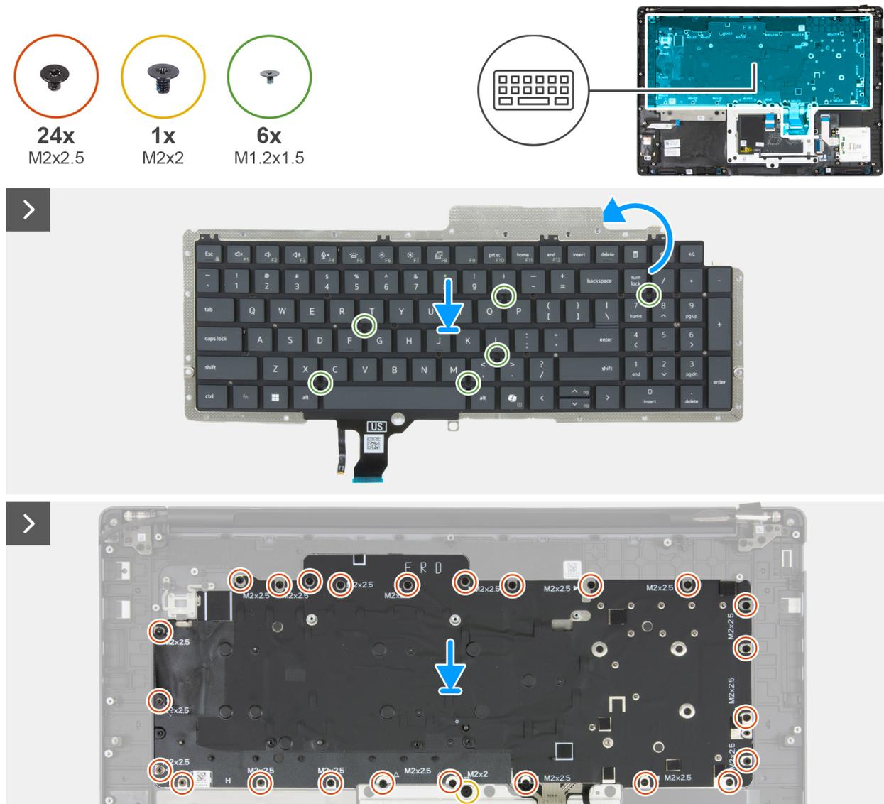
Figura 121. Installazione della tastiera
