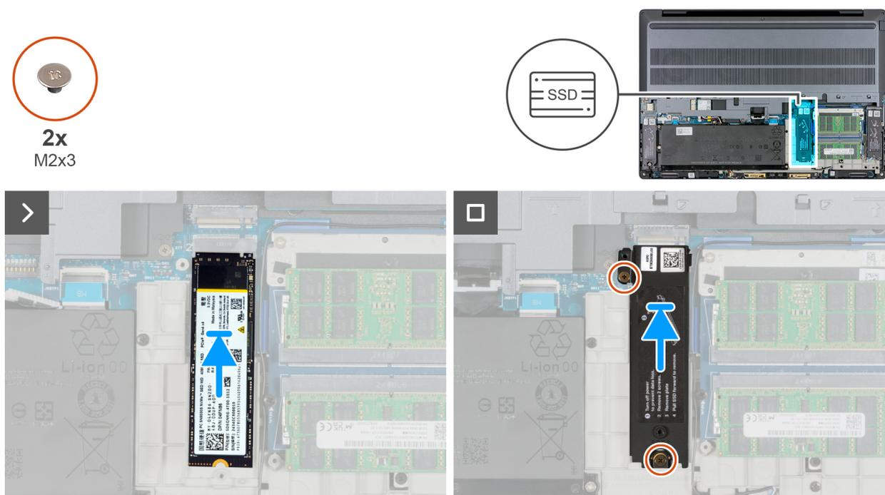
**Figura 39. Installazione dell'SSD M.2 2280 nello slot 2 (SSD2)**
