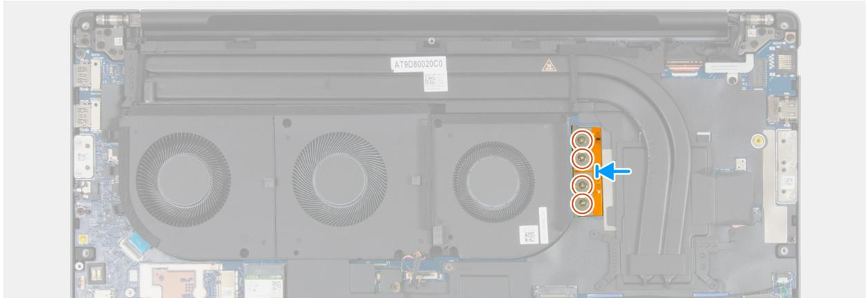
**Figura 58. Installazione del connettore del laser FPC integrato**
