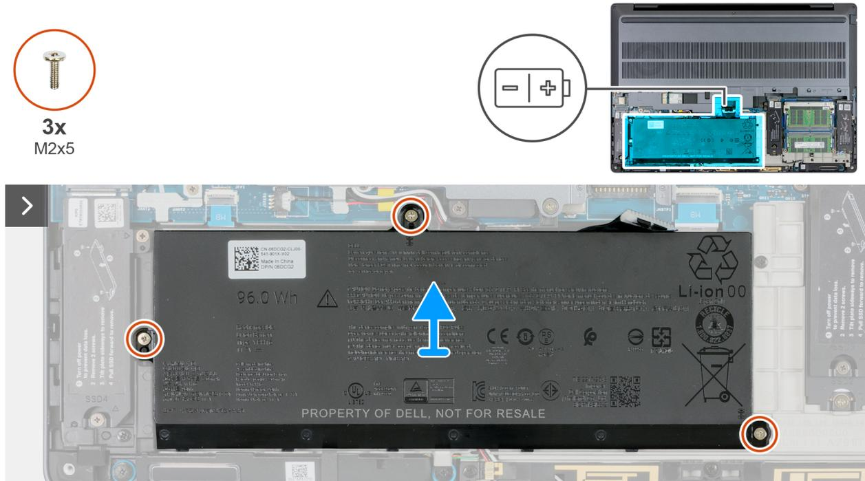
Figura 44. Rimozione della batteria
