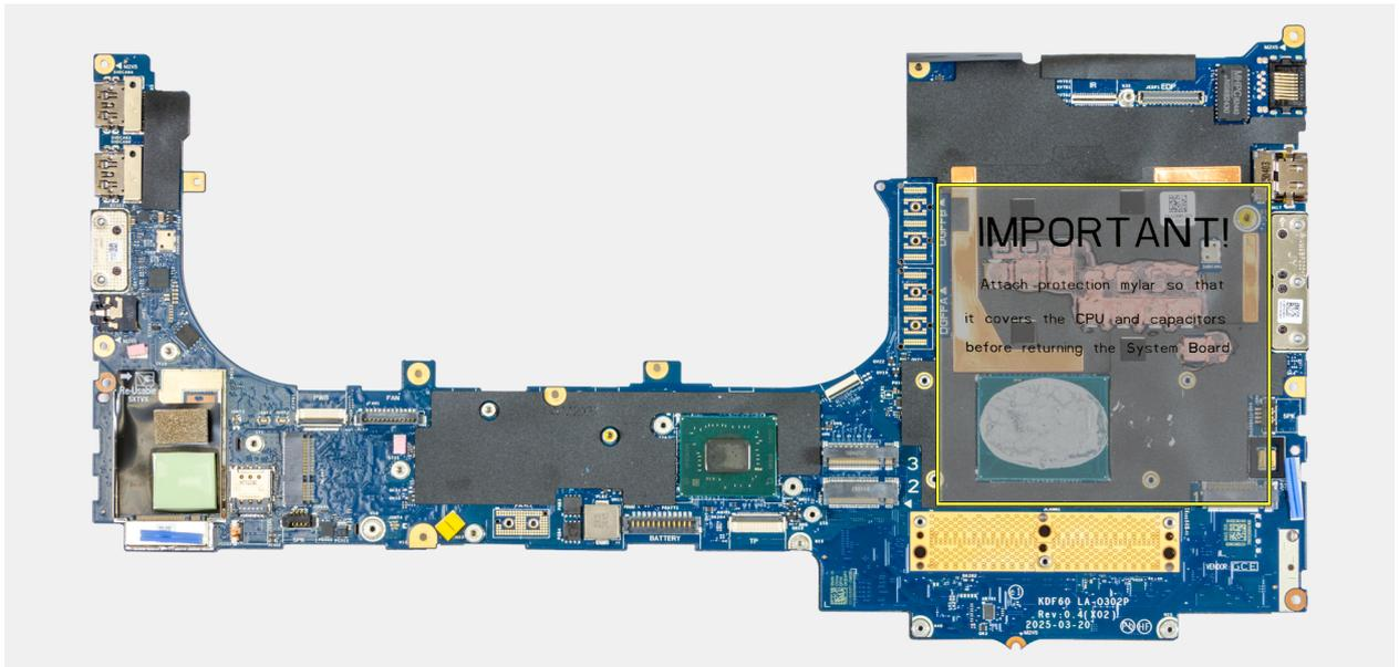
Figura 111. Preparazione della scheda di sistema difettosa per la restituzione
