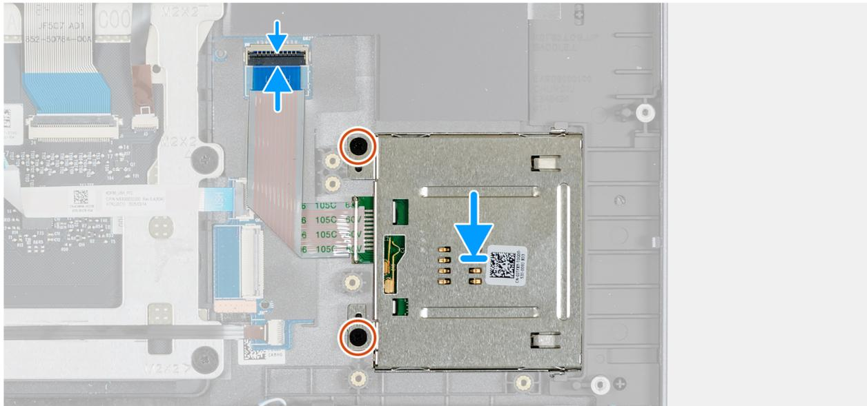
**Figura 124. Installazione del lettore di smart card**
