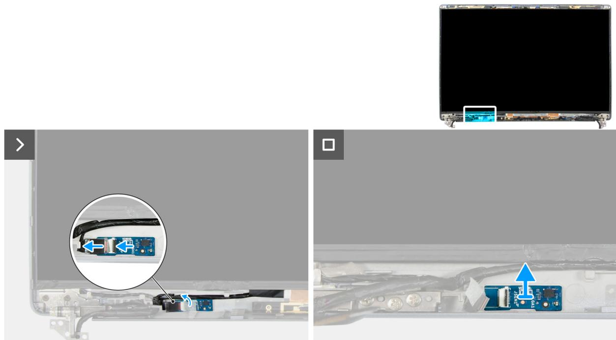
**Figura 101. Rimozione della scheda sensore**
