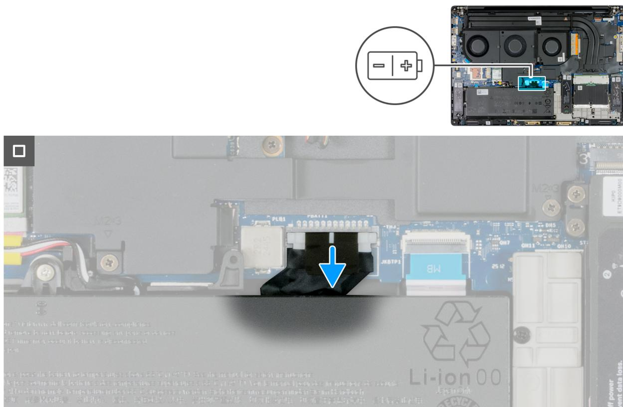
Figura 26. Scollegamento del cavo della batteria
