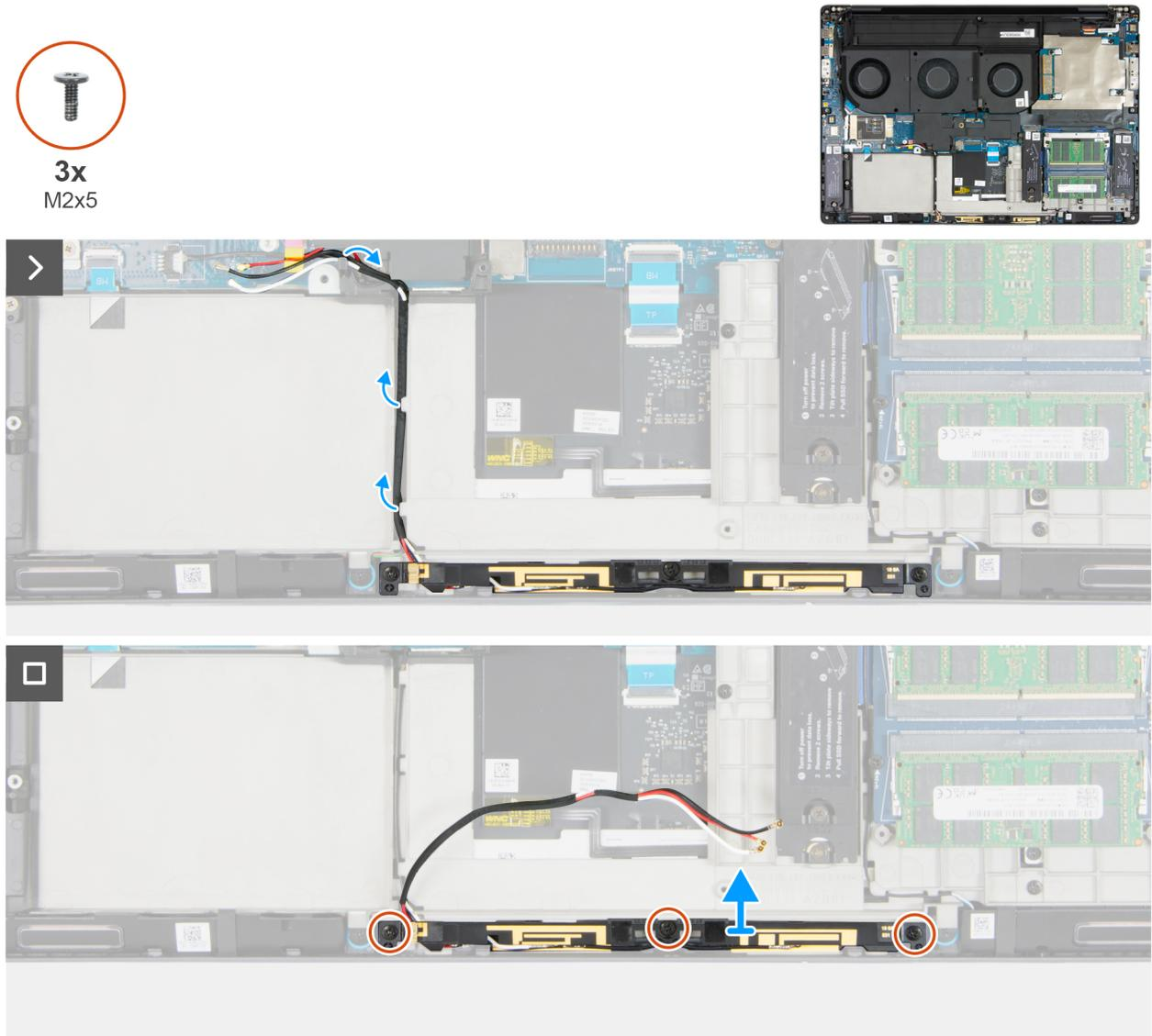
**Figura 77. Rimozione del modulo dell'antenna WLAN**
