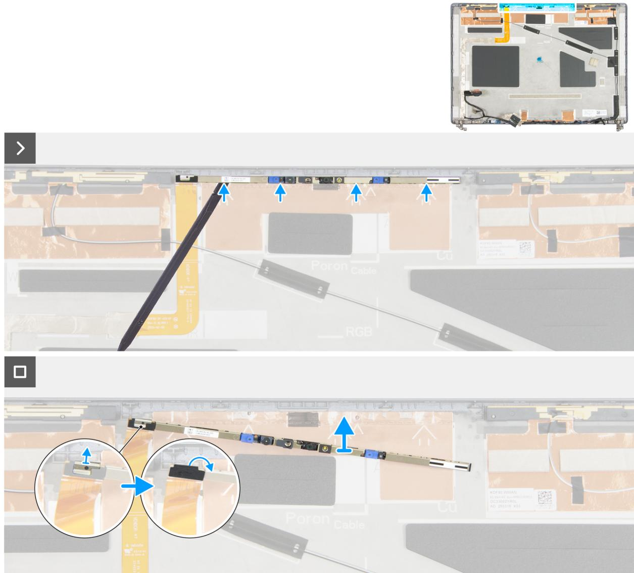
**Figura 103. Rimozione del modulo della fotocamera**
