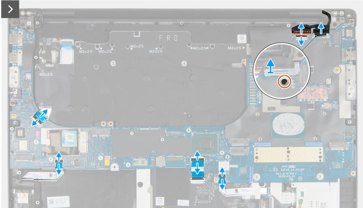
Figura 109. Rimozione della scheda di sistema
