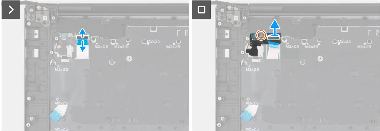
Figura 127. Rimozione della scheda del pulsante di accensione
