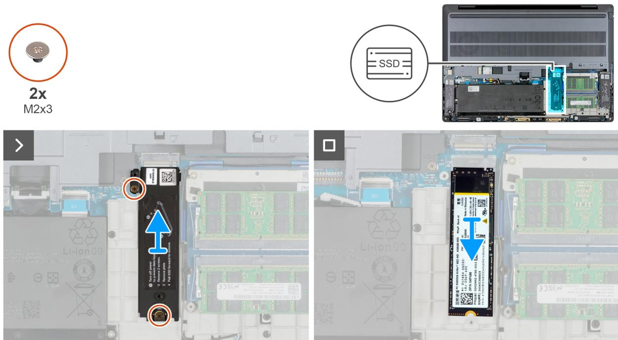
Figura 36. Rimozione dell'SSD M.2 2280 dallo slot 3 (SSD3)
