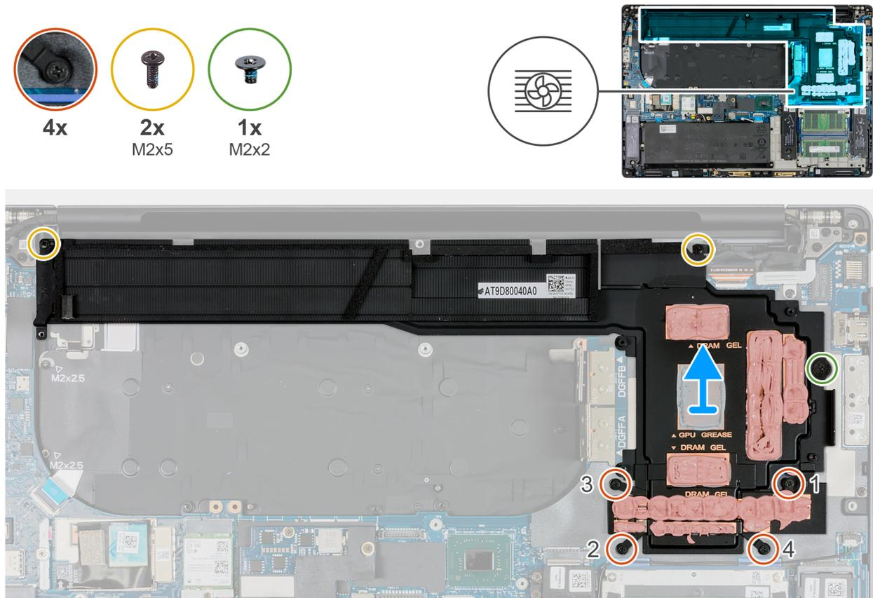
Figura 75. Rimozione del dissipatore di calore per computer forniti con scheda grafica dedicata
