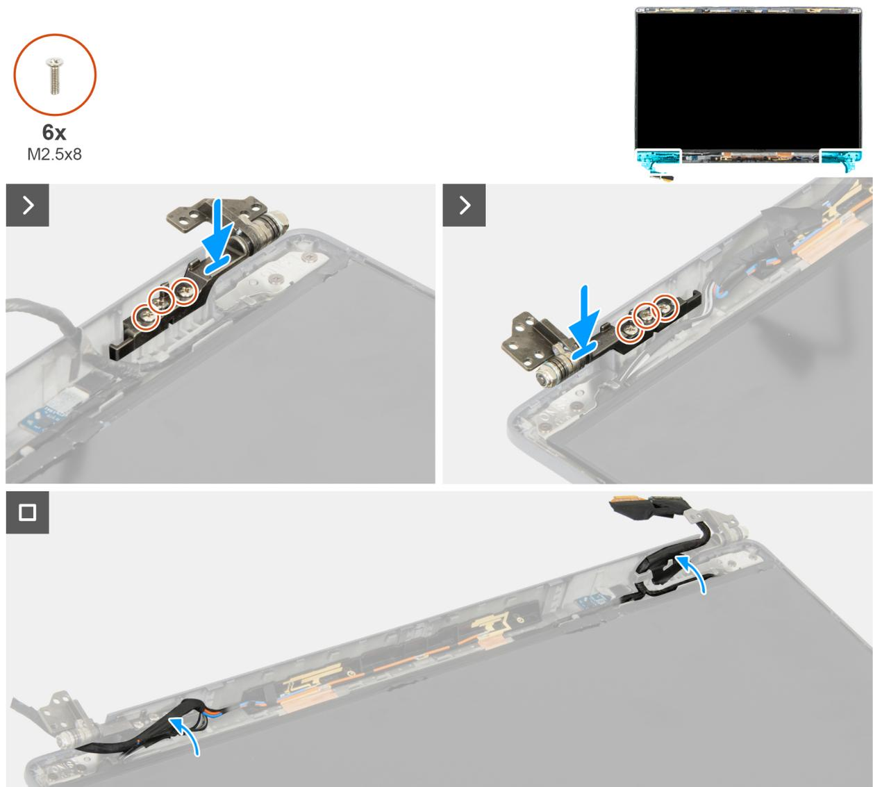
Figura 100. Installazione delle cerniere del display
