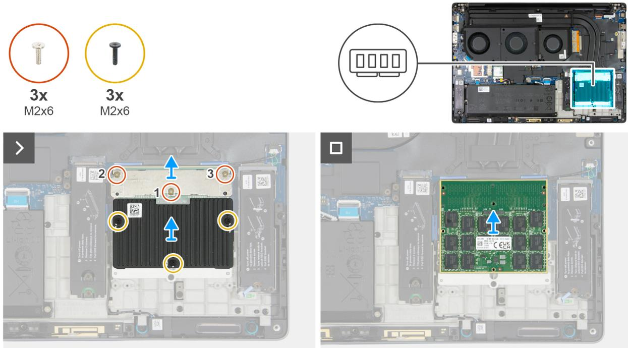
Figura 32. Rimozione del modulo CAMM
