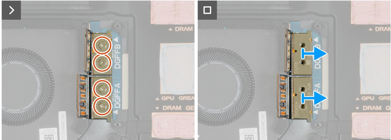
Figura 59. Rimozione del connettore del laser FPC dedicato
