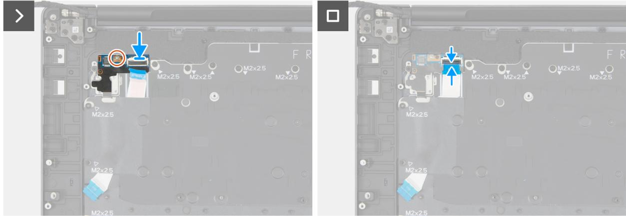
**Figura 128. Installazione della scheda del pulsante di alimentazione**
