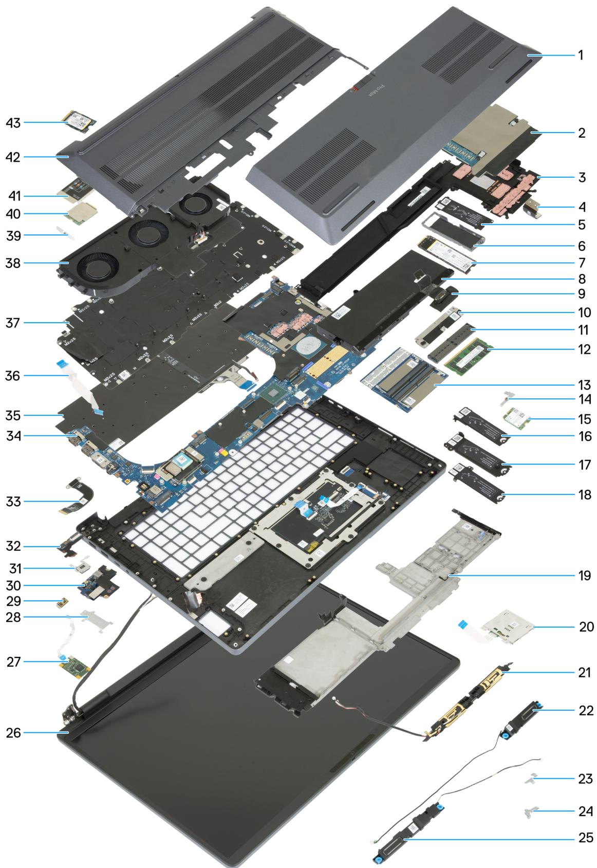
**Figura 9. Componenti principali di Dell Pro Max 18 Plus MB18250**
