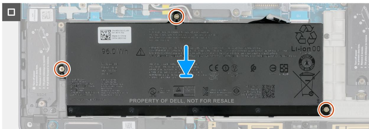
**Figura 47. Ricollocamento della batteria**
