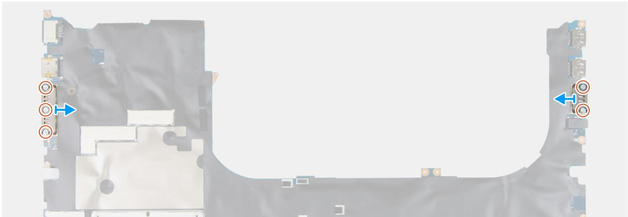
**Figura 115. Rimozione del modulo del connettore USB Type-C**
