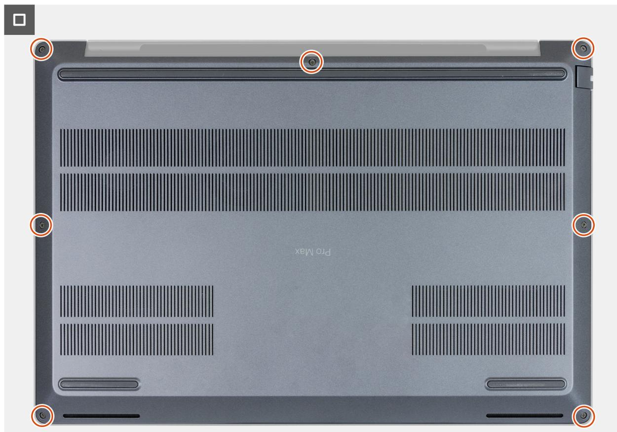
**Figura 29. Serraggio delle viti di fissaggio**
