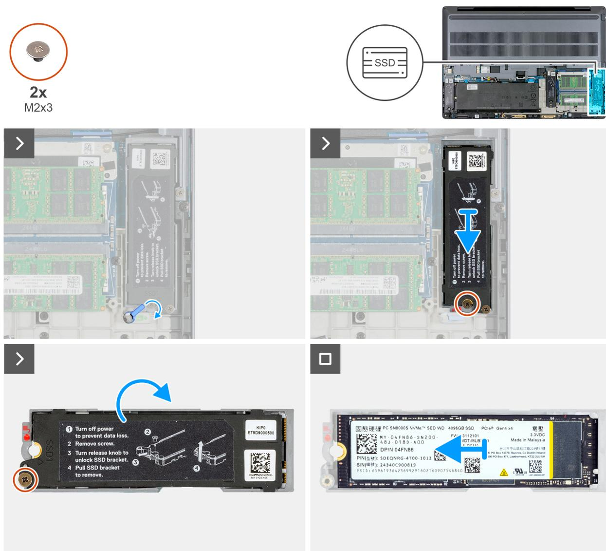
Figura 34. Rimozione dell'SSD M.2 2280 dallo slot 1 (SSD1)
