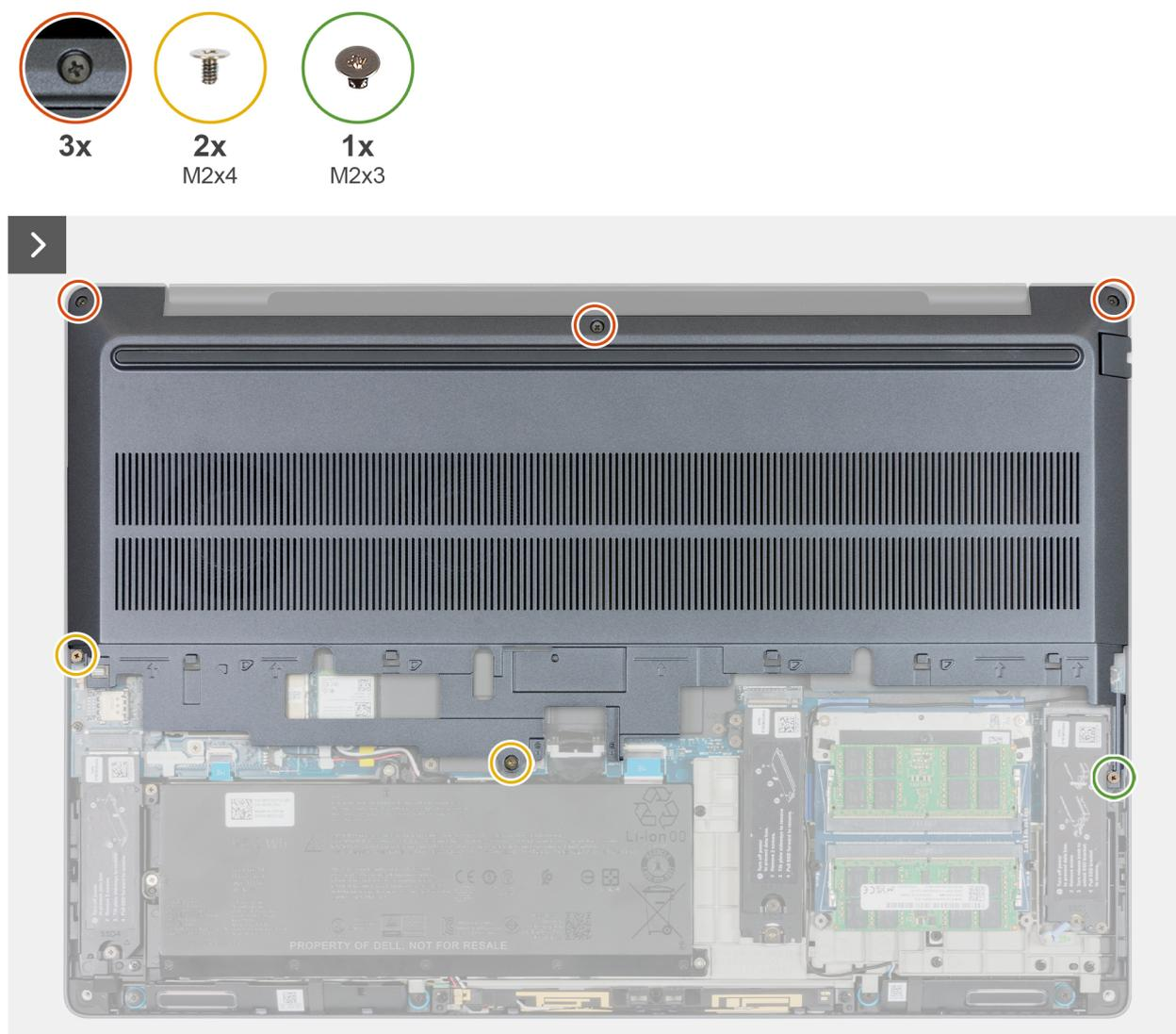
Figura 18. Allentamento delle tre viti di fissaggio e rimozione delle tre viti
