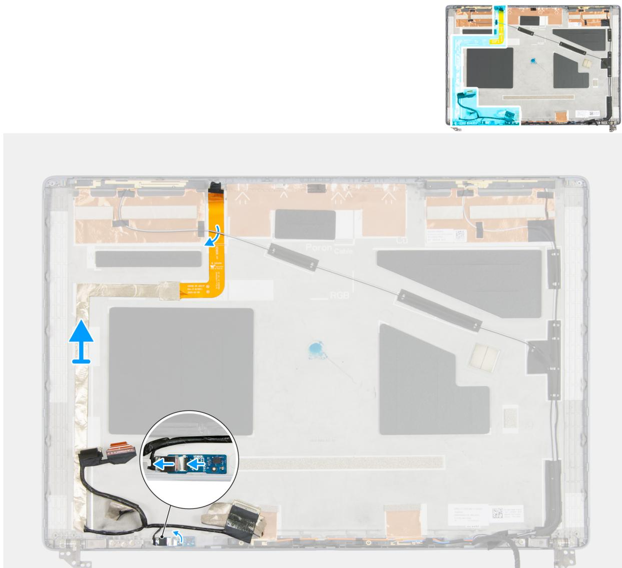
Figura 104. Rimozione del cavo del display
