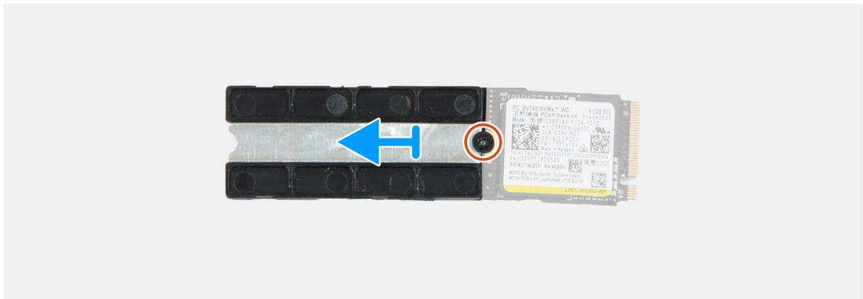
**Figura 42. Rimozione dell'SSD M.2 2230**
