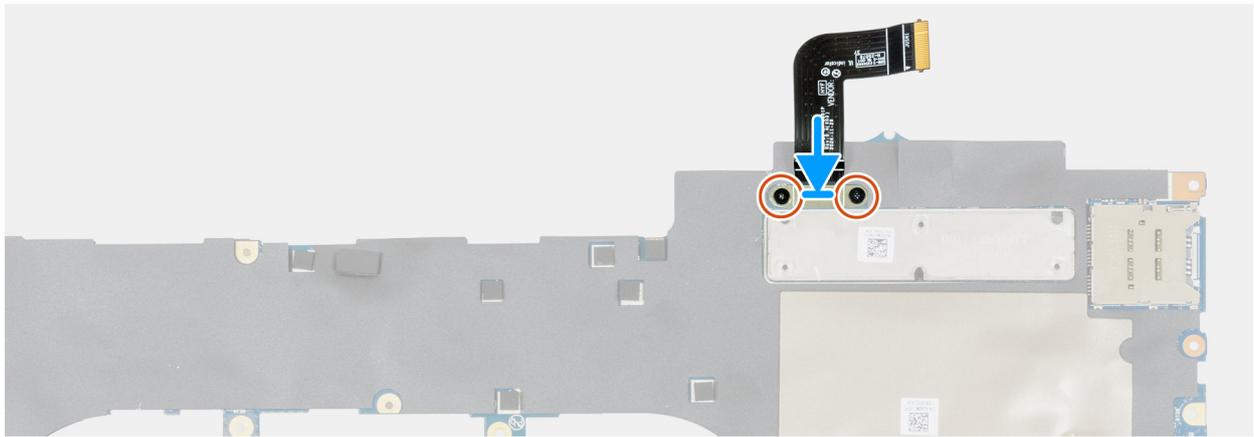
**Figura 118. Installazione del cavo della scheda USH**
