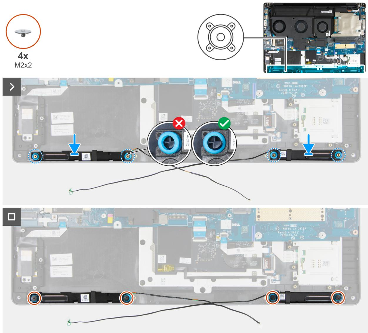
**Figura 82. Installazione degli altoparlanti**
