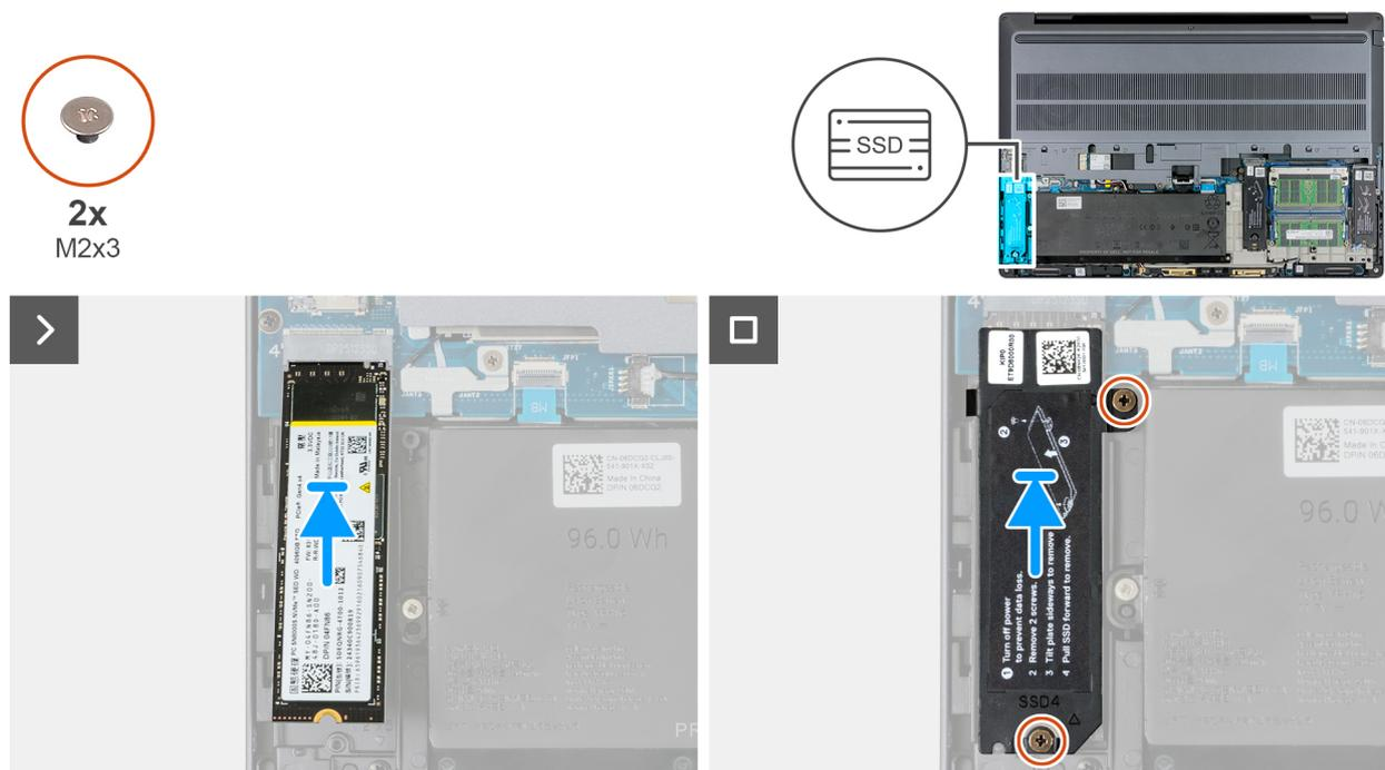
Figura 41. Installazione dell'SSD M.2 2280 nello slot 4 (SSD4)
