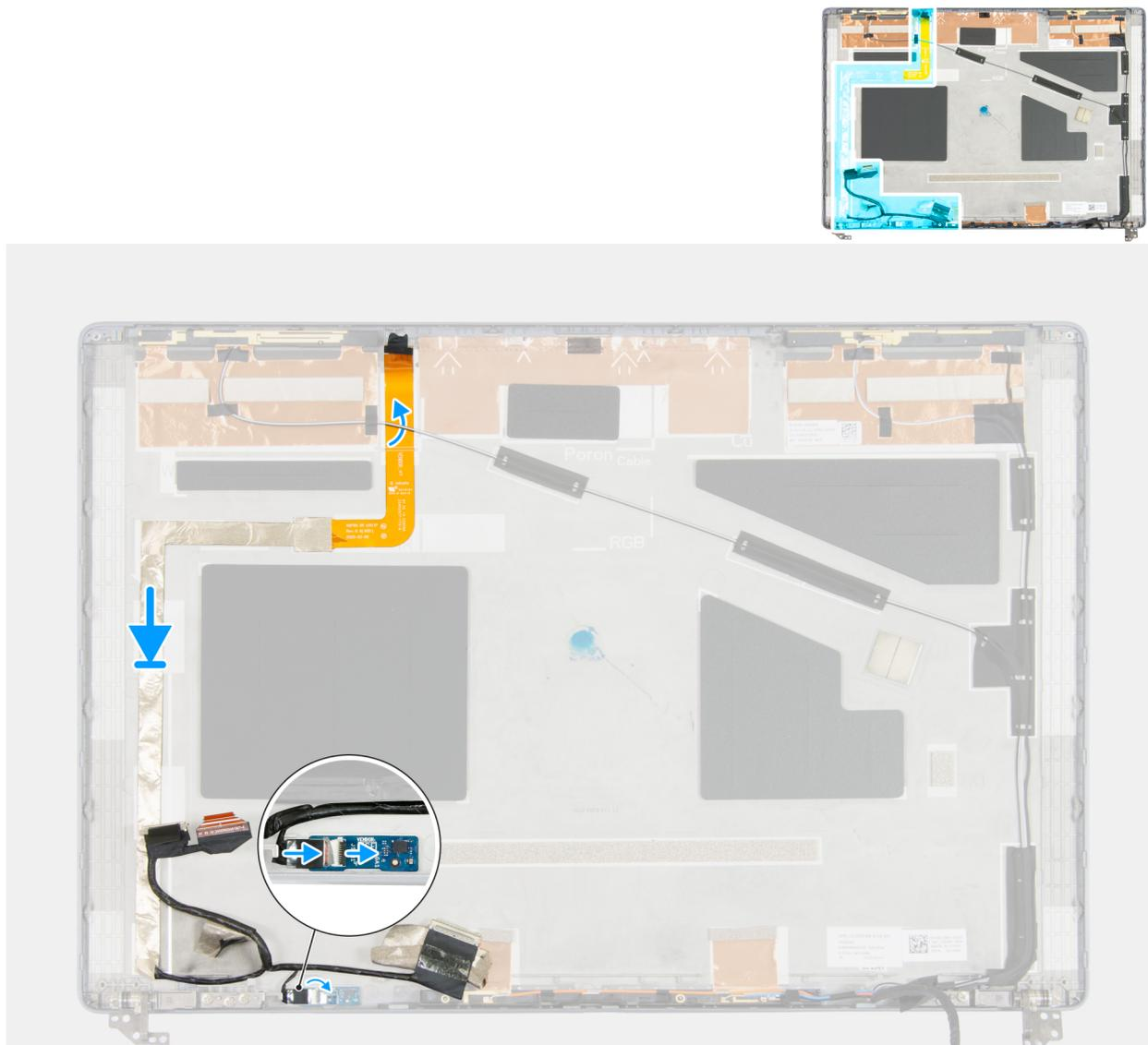
**Figura 105. Installazione del cavo del display**
