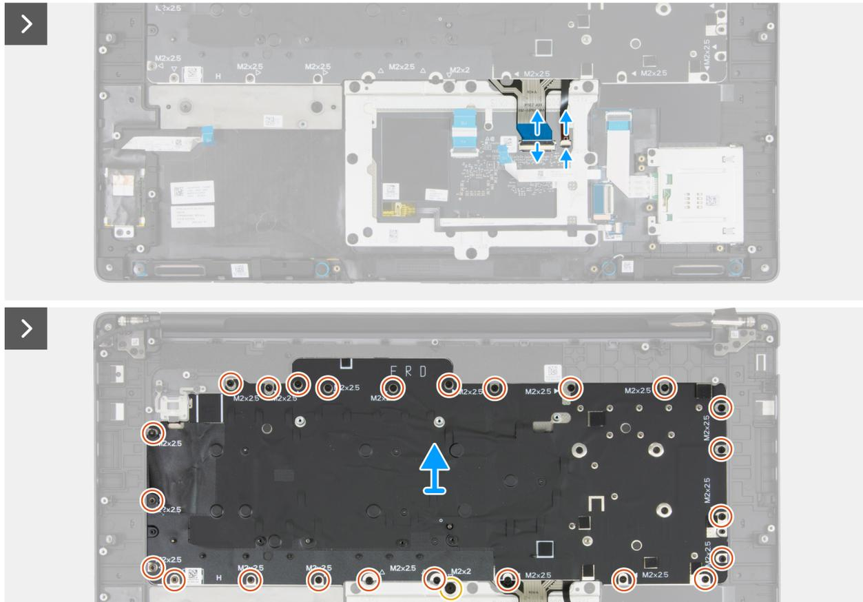
Figura 119. Rimozione della tastiera
