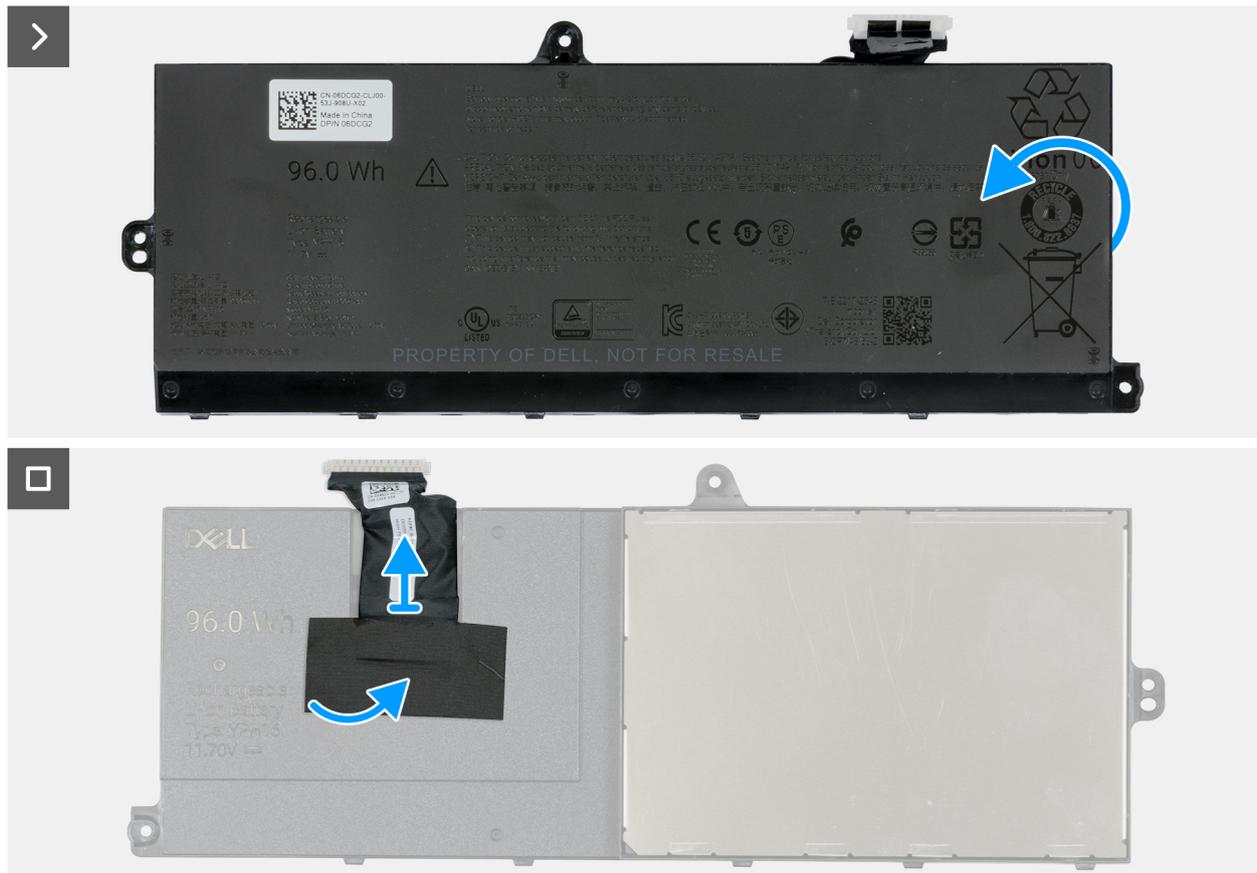
Figura 45. Rimozione del cavo della batteria dalla batteria
