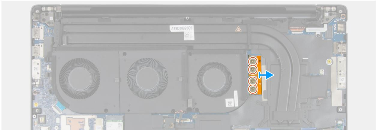
**Figura 57. Rimozione del connettore del laser FPC integrato**
