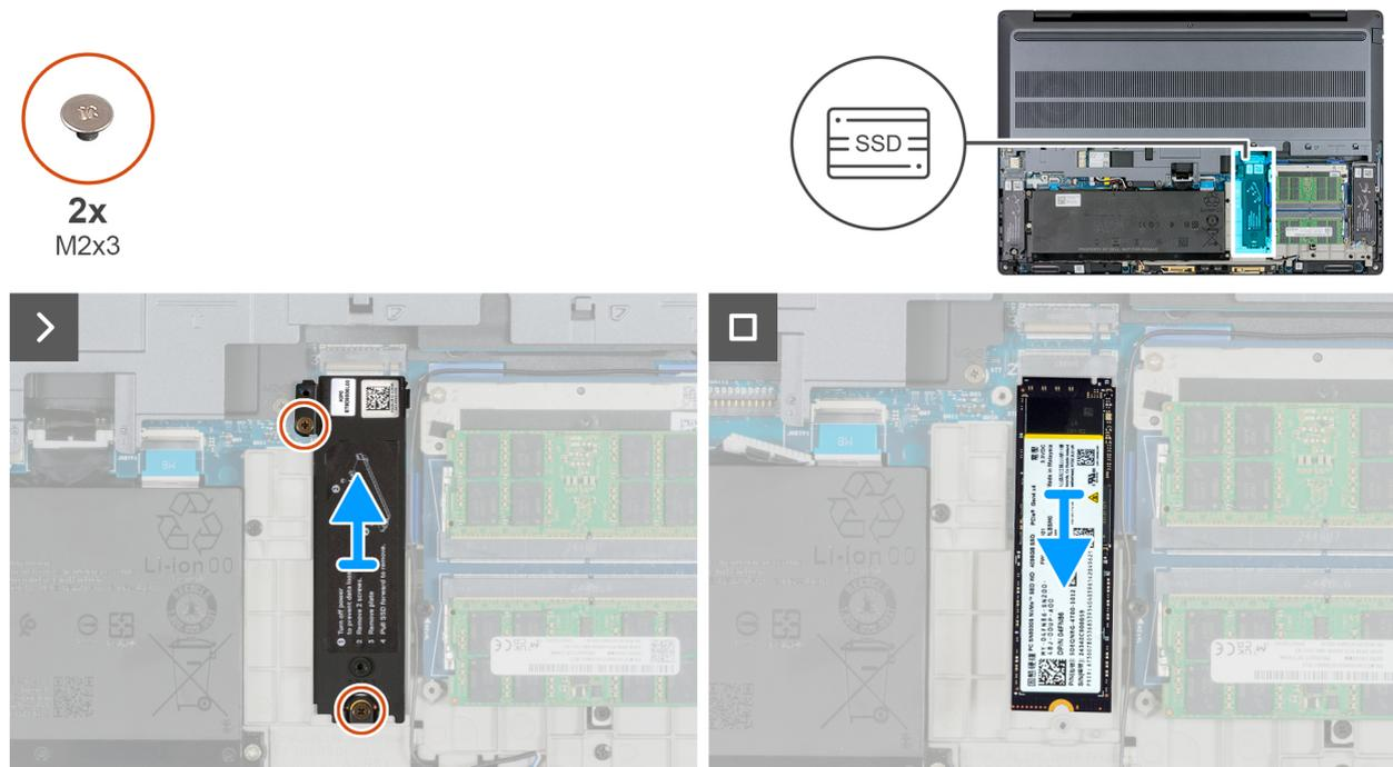
**Figura 38. Rimozione dell'SSD M.2 2280 dallo slot 2 (SSD2)**
