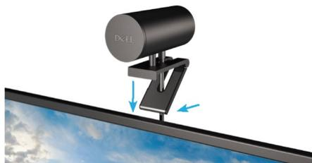
4. Premere la base del supporto per webcam verso il coperchio posteriore del monitor per assicurarsi che la webcam sia fissata saldamente.
