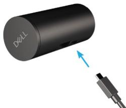
2. Allineare e inserire la testa di montaggio della webcam nello slot di montaggio della webcam sulla webcam.
