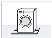
Collocare l'apparecchio su una base di legno resistente all'acqua (spessore minimo di 30 mm) ben fissata al pavimento.
