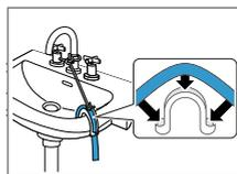
Fissare e assicurare il raccordo di scarico dell'acqua con un collettore → *Pagina 27.*
