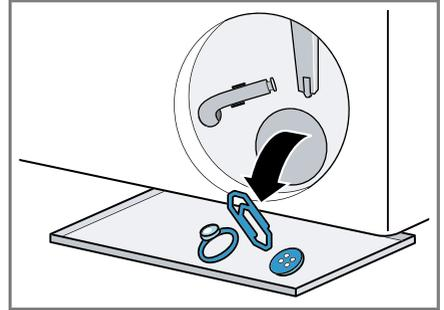
Il coperchio della pompa consta di due elementi costruttivi che possono essere smontati per essere puliti.
