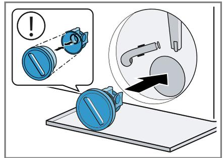
4. Chiudere il coperchio della pompa ruotandolo finché non si innesta. L'impugnatura del coperchio della pompa deve essere in posizione verticale.
