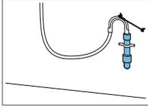
Fissare e assicurare il raccordo di scarico dell'acqua con un collettore → *Pagina 28.*
