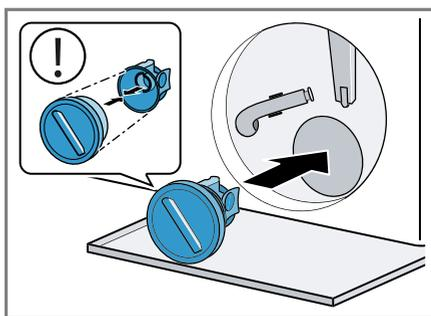
4. Chiudere il coperchio della pompa ruotandolo finché non si innesta. L'impugnatura del coperchio della pompa deve essere in posizione verticale.
