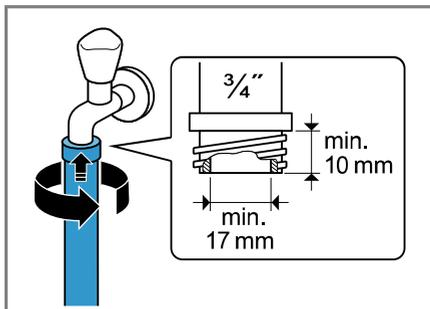
3. Aprire con precauzione il rubinetto dell'acqua e controllare la tenuta dei collegamenti.
