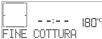
Ruotare la *manopola di regolazione* per prolungare la cottura impostando una nuova durata. In entrambi i casi, i parametri di cottura saranno mantenuti.
