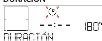
Cuando parpadee el ícono en la pantalla, utilice el *selector de ajuste* para ajustar el tiempo de cocción necesario y luego pulse *✓* para confirmar. Si quiere cocinar de forma manual no es necesario configurar el tiempo de cocción (sin tiempo programado: Pulse para confirmar e iniciar la función. En este caso, no puede configurar la hora de finalización de la cocción programando un inicio diferido).
