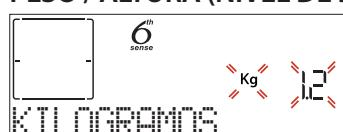
Para configurar la función correctamente, siga las indicaciones en la pantalla cuando se muestren y gire el **selector de ajuste** para establecer el valor deseado, después pulse para confirmar.
