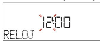
Gire el *selector de ajuste* para establecer la hora correcta y pulse *✓*: En la pantalla parpadean las dos cifras de los minutos. Gire el *selector de ajuste* para establecer los minutos y pulse *✓* para confirmar.
