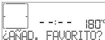
Si desea guardar una función como favorita y memorizar los ajustes actuales para el futuro, mantenga pulsado ✓ , si desea ignorar la solicitud, pulse << . Una vez pulsado ✓ , gire el selector de ajuste para seleccionar la posición, después pulse ✓ para confirmar.
