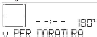
Quando il display mostra il messaggio corrispondente, premendo  $\checkmark$  viene avviato un ciclo di doratura di cinque minuti.
