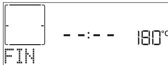
Gire el selector de ajuste para alargar el tiempo de cocción configurando una nueva duración. En ambos casos, los parámetros de cocción se mantendrán.
