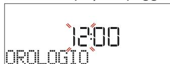
Ruotare la *manopola di regolazione* per impostare l'ora corretta e premere **✓**: sul display lampeggiano le due cifre relative ai minuti. Ruotare la *manopola di regolazione* per impostare i minuti e premere **✓** per confermare.
