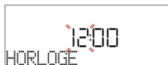
Tournez le *bouton de réglage* pour régler l'heure et appuyez sur *✓* : Les deux chiffres indiquant les minutes clignotent à l'écran. Tournez le *bouton de réglage* pour régler les minutes et appuyez sur *✓* pour confirmer.
