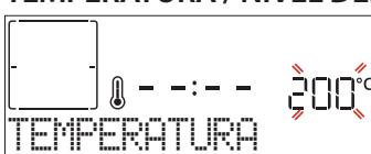
Cuando el valor parpadee en la pantalla, gire el *selector de ajuste* para cambiarlo, después pulse *✓* para confirmar y siga modificando la configuración siguiente (si es posible).
