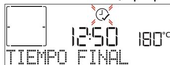
Gire el **selector de ajuste** para configurar la hora en la que quiere que termine la cocción y pulse para confirmar y activar la función.
