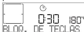
Nota: Esta función también puede activarse durante la cocción. Por motivos de seguridad, el horno se puede apagar en cualquier momento girando el selector hasta «0».
