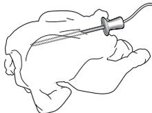
Introdurre gli alimenti nel forno e collegare lo spinotto inserendolo nell'apposita presa posizionata sul lato destro della cavità del forno.
