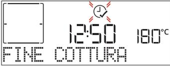
Premere  $+ \text{ o } -$  per impostare l'ora di fine cottura desiderata, quindi premere  $\checkmark$  per confermare e attivare la funzione. Inserire il cibo nel forno e chiudere la porta: la funzione si avvierà automaticamente dopo un periodo di tempo calcolato per terminare la cottura all'orario impostato.
