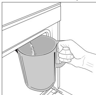
Dopo avere selezionato la funzione "Scarico", o quando richiesto dal messaggio corrispondente sul display, avviare la funzione ed eseguire le operazioni indicate: aprire la porta e disporre una caraffa capiente (con capacità di almeno 2 litri) sotto l'ugello di scarico situato sul fondo del pannello, a
