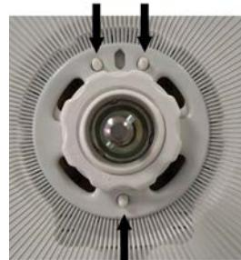
E. Das Lüfterrad (13) auf die Motorwelle (5) schieben und mit der entsprechenden Nutmutter (16) festspannen (gegen den Uhrzeigersinn drehen und festziehen).
