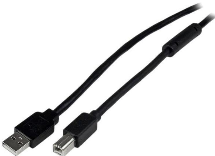
Il cavo USB A a B da 20 m USB2HAB65AC comprende la circuiteria attiva alimentata tramite bus che consente prestazioni oltre il limite della lunghezza di 5 metri di un cavo USB standard.
