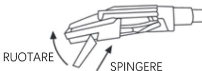
Per riposizionare la puntina tenere i lati del supporto rosso della puntina, assicurarsi che questa sia rivolta verso il basso e spingere delicatamente il supporto con un angolo minimo verso la testina all'estremità del braccio di riproduzione fino a quando non è saldamente fissata.
