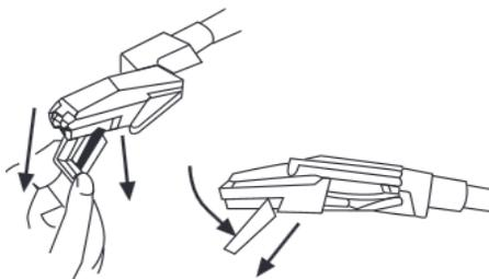
Per rimuovere la puntina afferrare saldamente il braccio di riproduzione e il supporto in plastica della puntina con due dita e tirare delicatamente il supporto rosso della puntina verso di sé, allontanandolo dalla testina.
