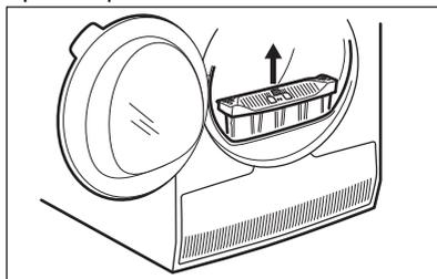
2. Aprire la copertura del condensatore.
