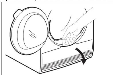
3. Ruotare la leva per sbloccare il coperchio del condensatore.
