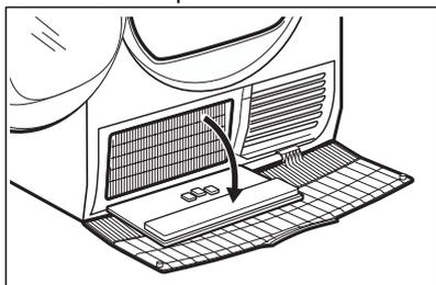
5. Se necessario, togliere la lanugine dal condensatore e dal suo alloggiamento. È possibile utilizzare un aspirapolvere con l'accessorio spazzola.
