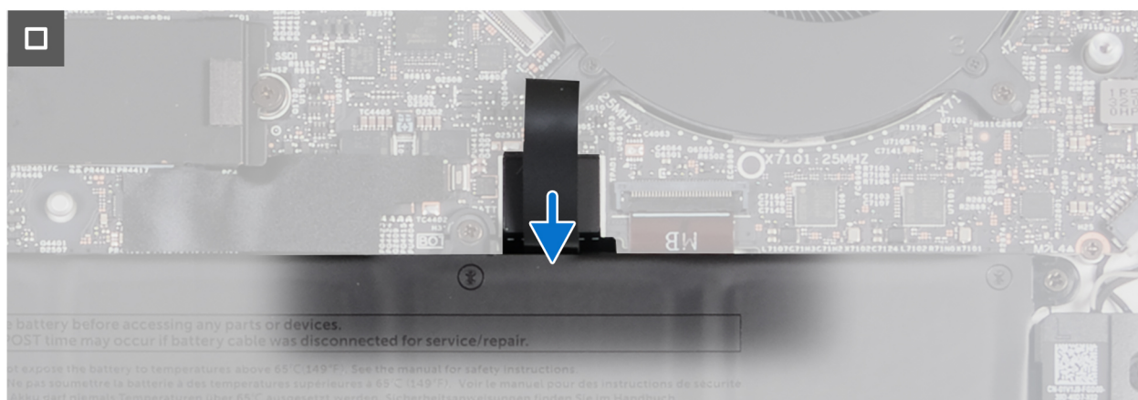
Figura 6. Scollegamento del cavo della batteria
