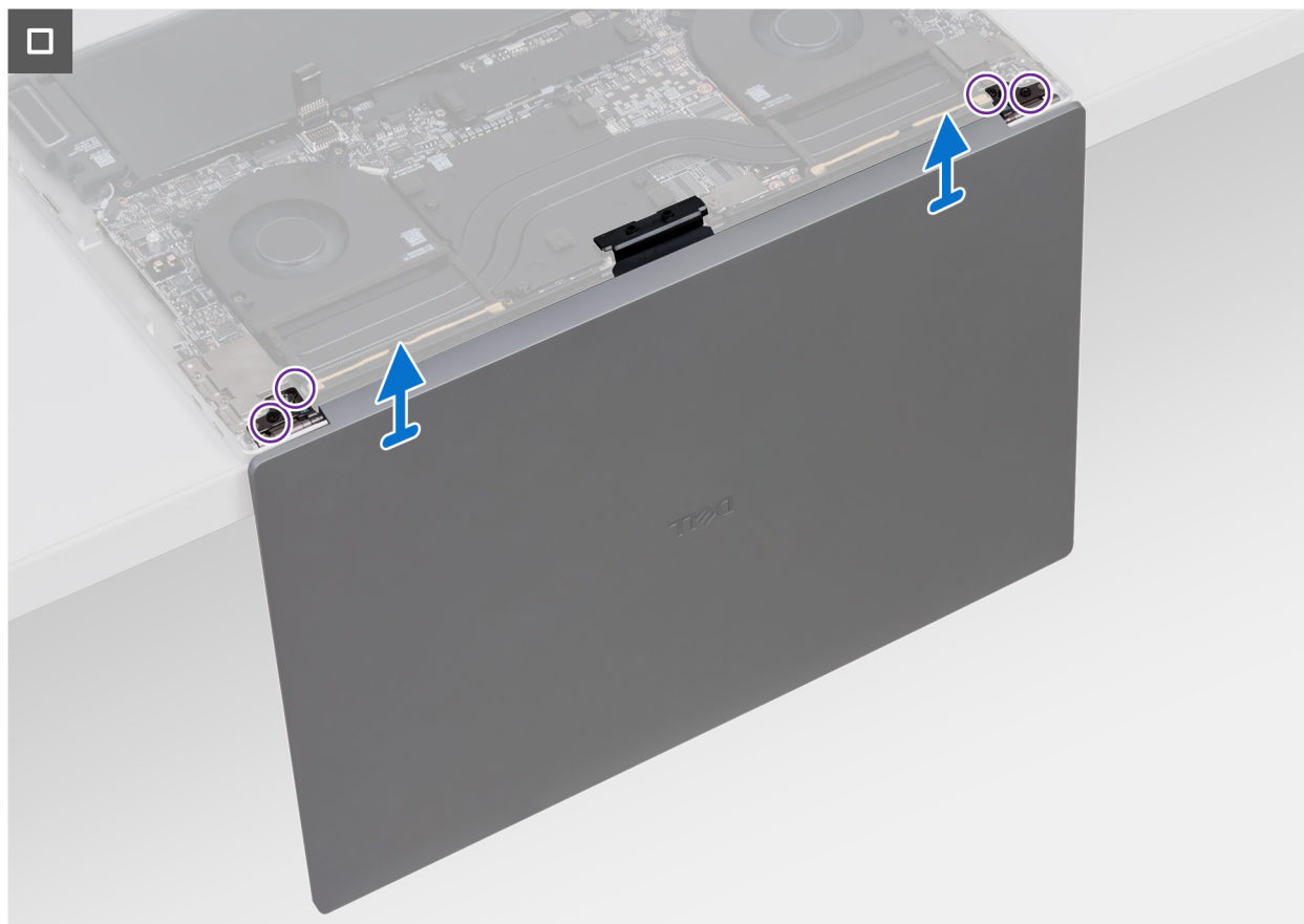
Figura 24. Rimozione del gruppo del display
