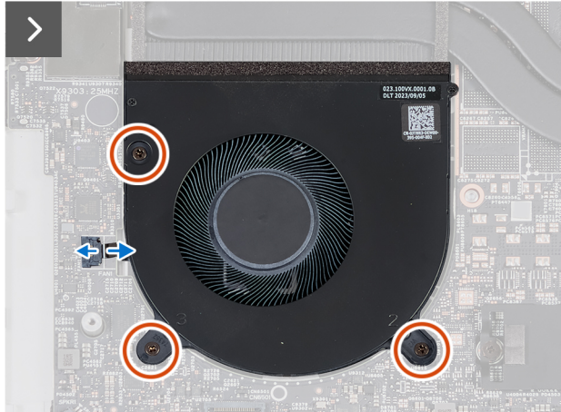
Figura 16. Rimozione della ventola della GPU
