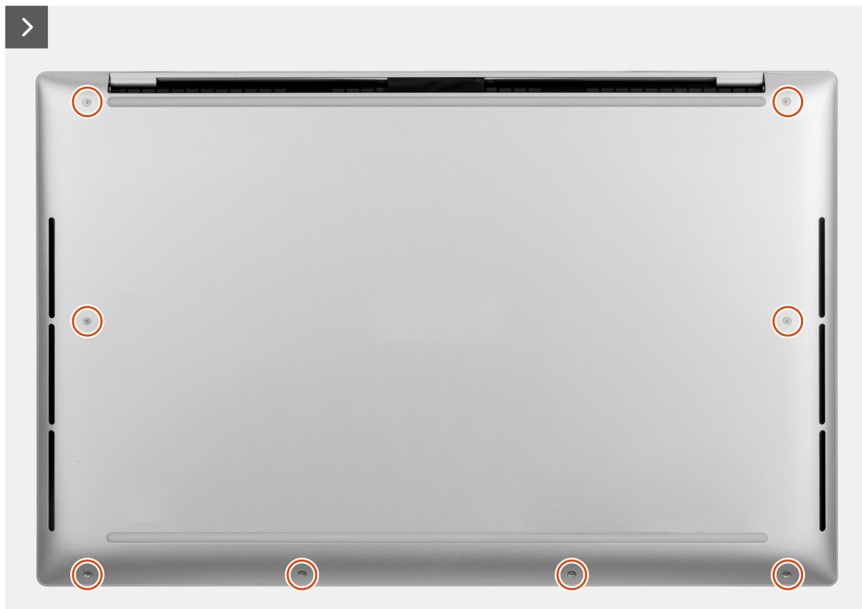
Figura 3. Rimozione del coperchio della base
