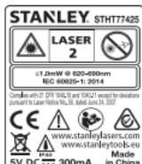
De TLM30 (STHT1-77425 of STHT1-77425W) stuurt een zichtbare laser-straal uit, zoals wordt getoond in Afbeelding A. De laser-straal die wordt uitgestuurd is van Laser-klasse 2 volgens IEC 60825-1 en voldoet aan 21 CFR 1040.10 en 1040.11 Met uitzondering van afwijkingen volgens Laser-kennisgeving Nr. 50, gedateerd 24 juni, 2007.
