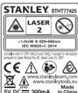
**BG** Инструментът TLM30 (STHT1-77425 или STHT1-77425W) излъчва видим лазерен лъч, както е показано на фигура. Излъчваният лазерни лъчи е лазер клас 2 от IEC 60825-1 и е в съответствие с 21 CFR 1040.10 и 1040.11 с изключение на отклоненията съгласно известие относно лазерите № 50 от 24 юни 2007г.
