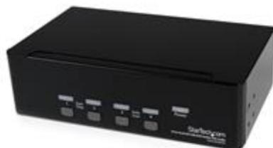
Lo switch KVM Dual DVI USB a 4 porte SV431DD2DUA consente fino a quattro PC dotati ognuno di porte Dual DVI di condividere due monitor, un microfono e altoparlanti, una tastiera e un mouse nonché altre due periferiche USB.
