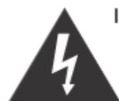
Il triangolo equilatero con al suo interno una freccia intende allertare l'utente della presenza di "voltage pericoloso" non isolato in grado di provocare un rischio di corto circuito.
