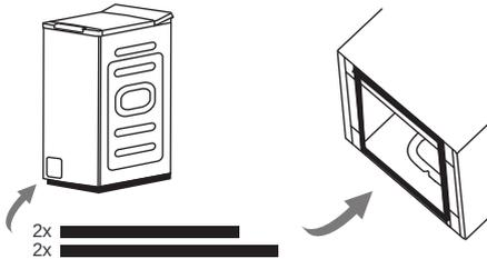
1. Posiziona la macchina con il fianco sul il pavimento, utilizzando un materiale morbido
