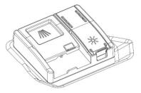
Il brillantante accelera l'asciugatura delle stoviglie ed impedisce la formazione di macchie e depositi calcarei; viene aggiunto automaticamente all'acqua durante l'ultimo risciacquo, dal serbatoio che si trova sul lato interno della porta.
