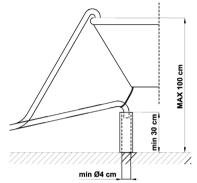
È importante evitare che il tubo possa sganciarsi e cadere. A tal proposito il reggitubo è dotato di un foro, grazie al quale è possibile fissarlo con un laccio al muro o al rubinetto. L'estremità libera andrà collocata ad un'altezza compresa tra 30 e 100 cm e non dovrà mai trovarsi immersa nell'acqua. In presenza di tubi di prolunga disposti orizzontalmente, per un massimo di 3 m, posizionare il tubo di scarico ad un'altezza max. di 85 cm dal suolo.
