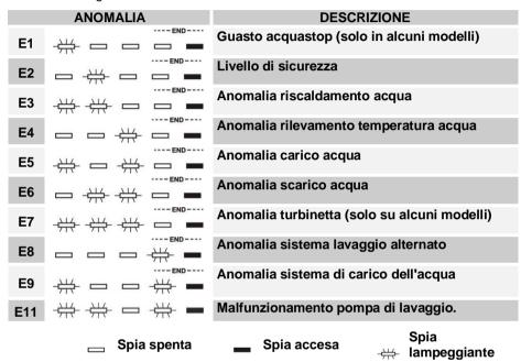
In caso del verificarsi di una situazione di allarme, la macchina interrompe il programma in corso segnalando l'anomalia.
