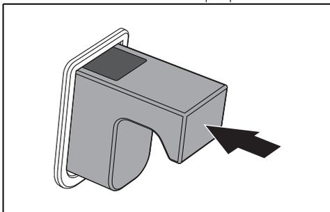
In presenza di troppa acqua nel serbatoio, l'acqua in eccesso defluirà all'interno del vano cottura:
