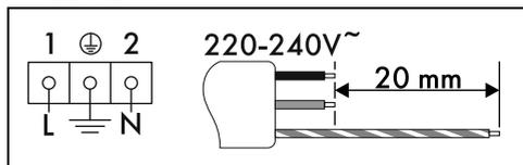
Cavo tripolare 3 x 1,5 mm<sup>2</sup>.
