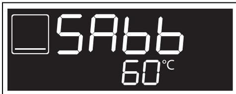
4. Ruotare la manopola temperatura per selezionare la temperatura desiderata (ad esempio "90°C").
