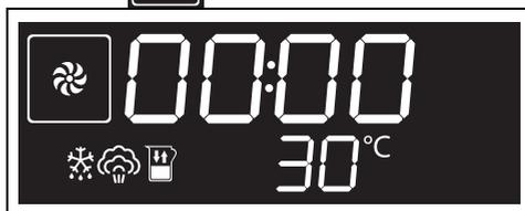
6. Ruotare la manopola temperatura per inserire la durata dello scongelamento (da 1 minuto a 13 ore) (ad esempio "1:30").
