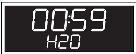
Al termine l'apparecchio emette un segnale acustico ed il display mostra la richiesta di scarico del serbatoio.
