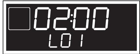
3. Ruotare la manopola temperatura per impostare la durata della Pirolisi da un minimo di 2 ore fino ad un massimo di 3 ore.
