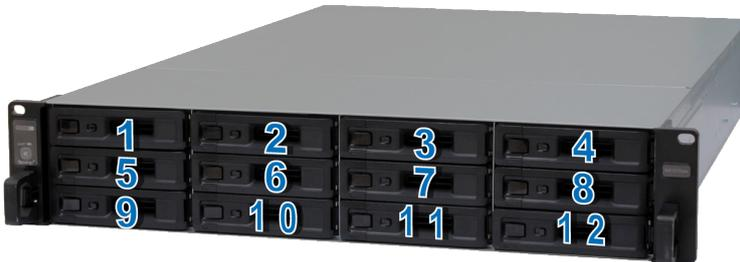
**Nota:** per creare un volume RAID, si raccomanda che tutte le unità installate abbiano le stesse dimensioni per un utilizzo ottimale della loro capacità.
