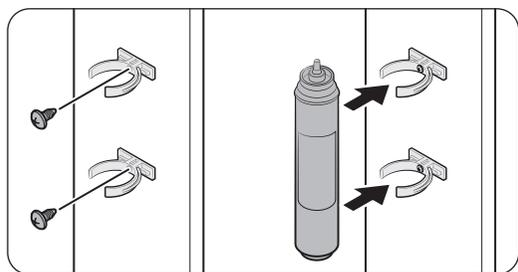
1. Collegare le **clip di fissaggio** (x2) nelle posizioni appropriate sotto il lavandino, per esempio. Quindi, fissare le **clip di fissaggio** saldamente usando le viti.
