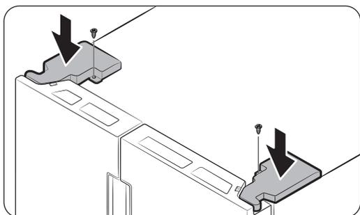
5. Inserire le coperture delle cerniere iniziando dai lati anteriori, quindi serrare le viti. In questo passaggio usare un cacciavite Phillips.
