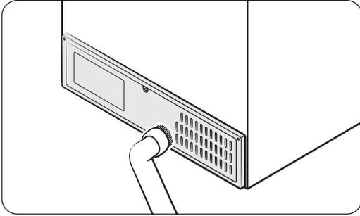
Per mantenere i cavi e le parti esposte del pannello posteriore prive di sporco, pulire con l'aspirapolvere il pannello una o due volte all'anno.
