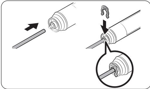
4. Controllare l'eventuale presenza di perdite. Se non ve ne sono, fissare le linee con le clip.
