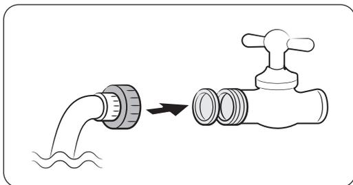
1. Montare la tubazione dell'acqua utilizzando i giunti.
