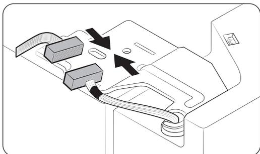
4. Collegare il cablaggio elettrico.
