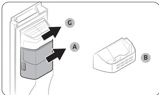
Se non si utilizza la macchina del ghiaccio e si necessita di più spazio, rimuovere il **contenitore della macchina del ghiaccio (A)** e le **copertura della macchina del ghiaccio (G)**. Quindi, inserire la **protezione del congelatore (opzionale) (B)** al posto del contenitore della macchina del ghiaccio.
