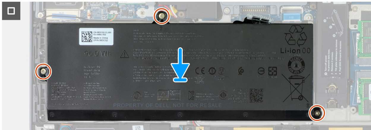
Figura 45. Ricollocamento della batteria
