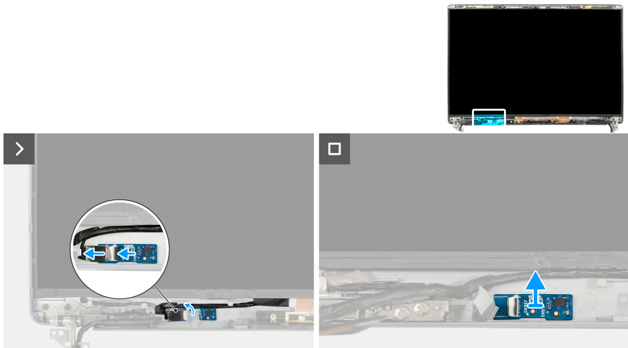
Figura 101. Rimozione della scheda sensore
