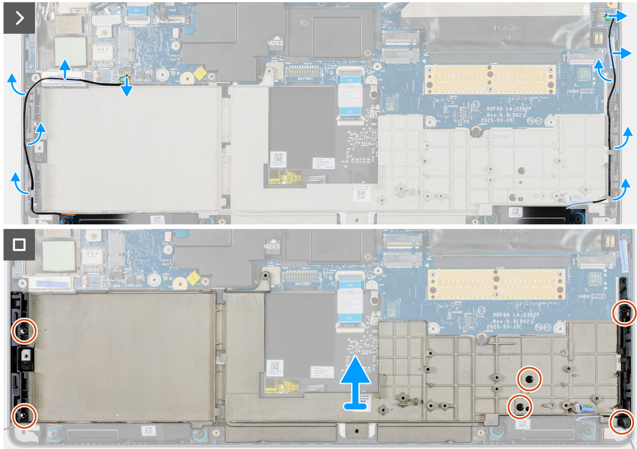
Figura 79. Rimozione dell'intelaiatura interna
