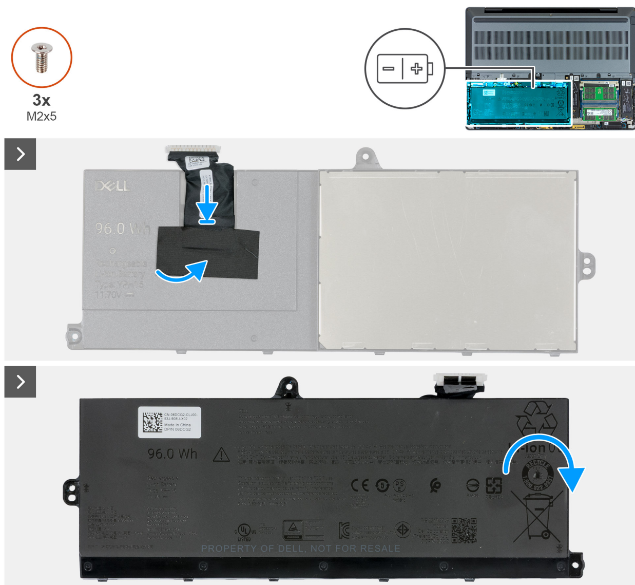
Figura 44. Ricollocamento del cavo della batteria
