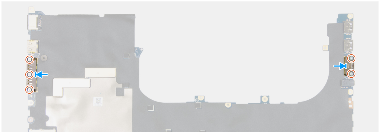
Figura 118. Installazione del modulo del connettore USB Type-C
