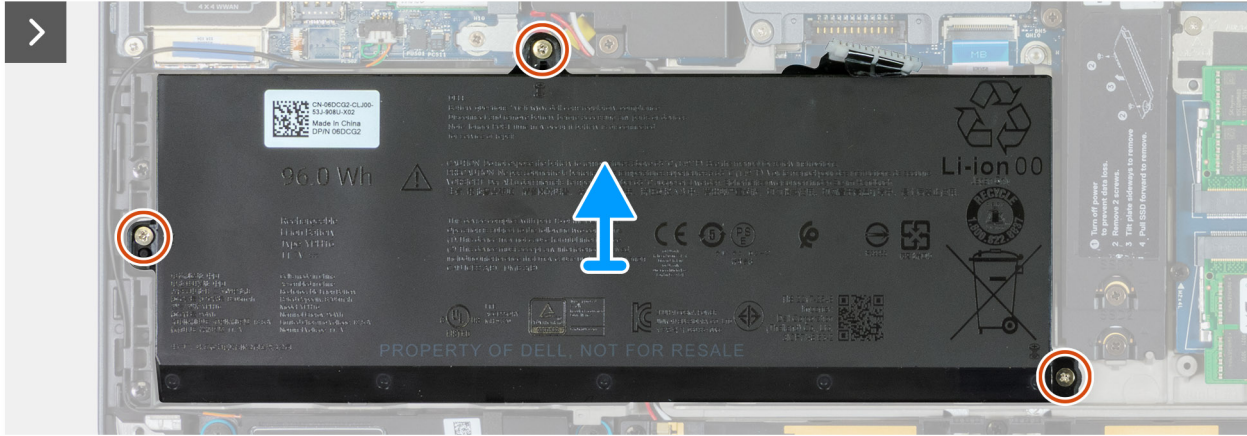
Figura 42. Rimozione della batteria
