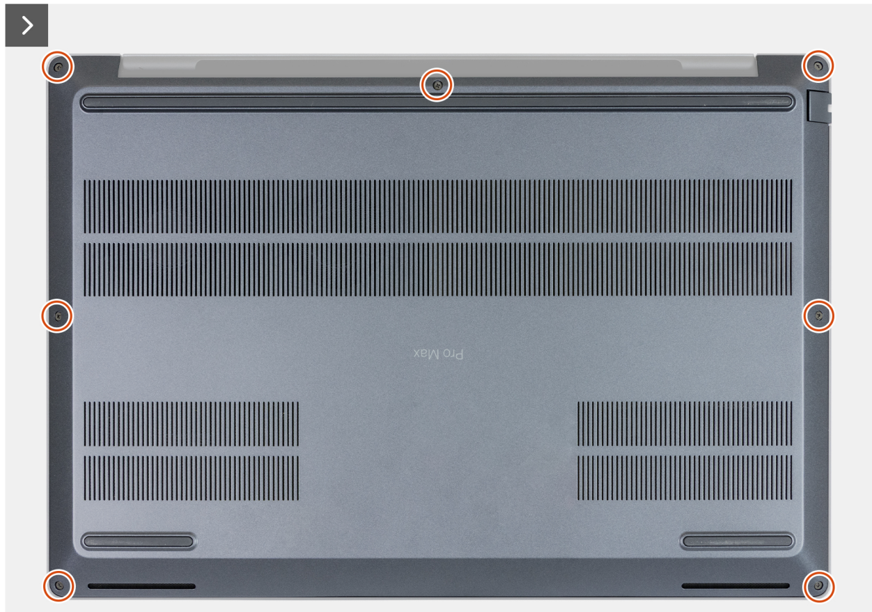
Figura 24. Allentamento delle viti di fissaggio
