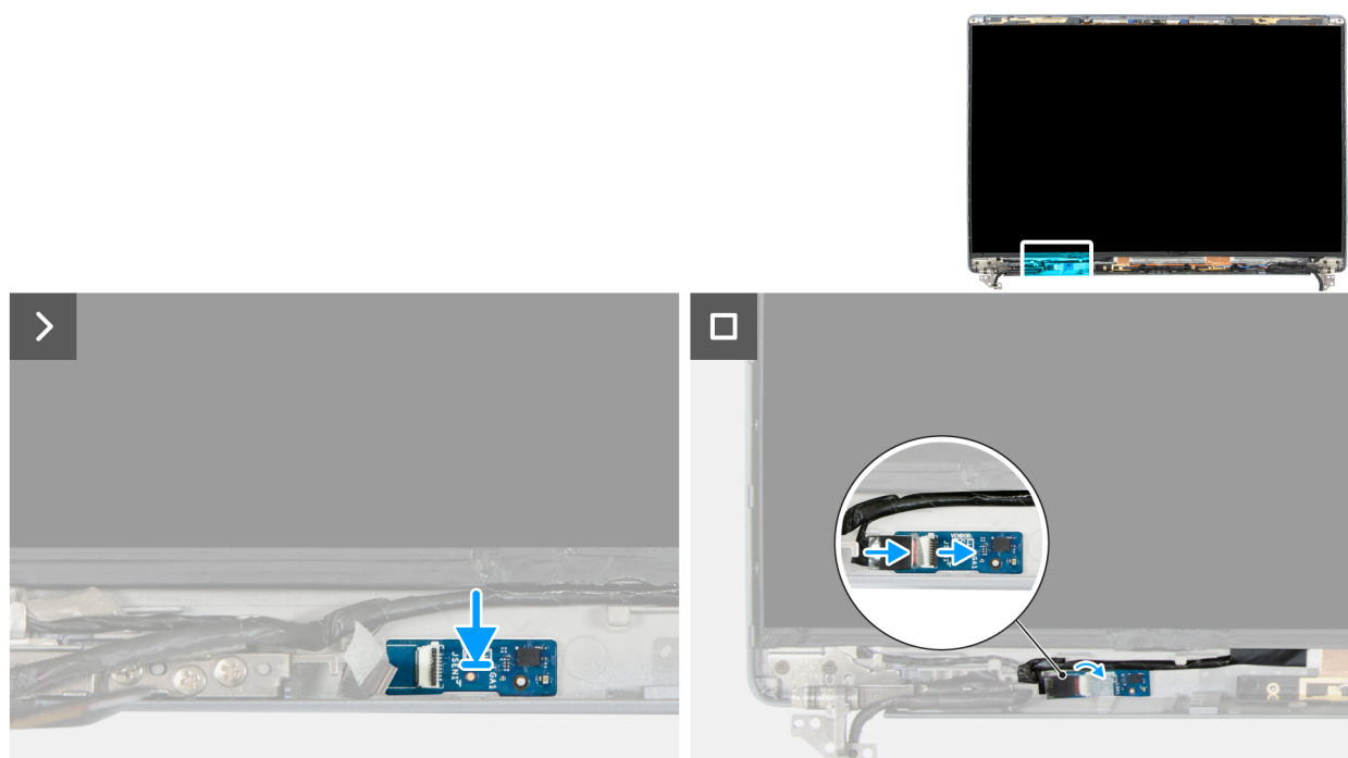
Figura 102. Installazione della scheda sensore
