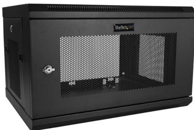
Grazie a questo armadietto rack per server 6U è possibile installare le apparecchiature conformi alla specifica EIA-310 su una parete. Il box esterno è compatibile con una capacità di carico massima di 90 kg e una profondità di installazione fino a 43 cm.
