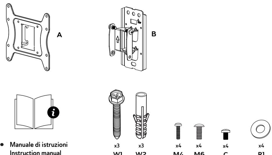
**1** IT Appoggiate la parte di staffa destinata alla TV e fissatela ai fori utilizzando le viti adatte (M4/M6) e le rondelle (R1).
