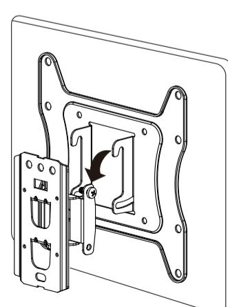
IT Terminate l'installazione applicando 2 viti (M6) di sicurezza. Se necessario, prima di stringere queste due viti, regolate l'inclinazione dello schermo.
