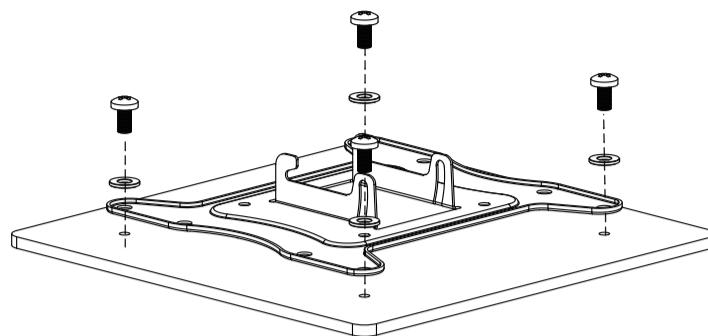
**DE** Platzieren Sie den Teil der Halterung für den Fernseher und befestigen Sie ihn mit den passenden Schrauben (M4/M6) und Unterlegscheiben (R1) an den Löchern.
