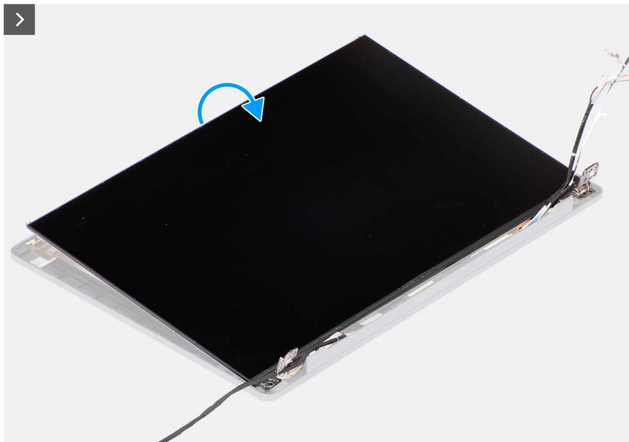
Figura 65. Rimozione del pannello del display
