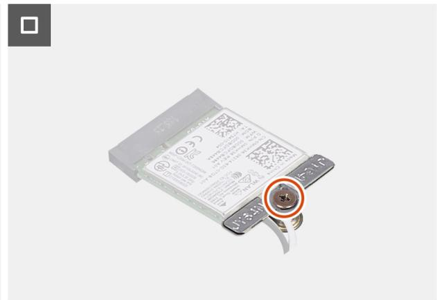
Figura 26. Installazione della scheda wireless
