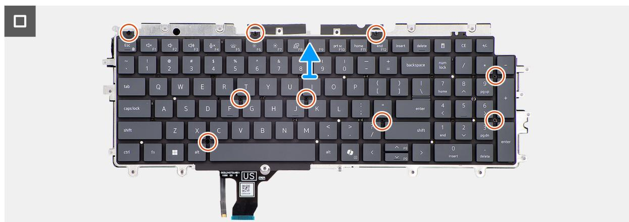
Figura 89. Rimozione della tastiera
