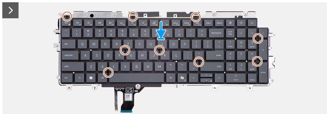
Figura 90. Installazione della tastiera
