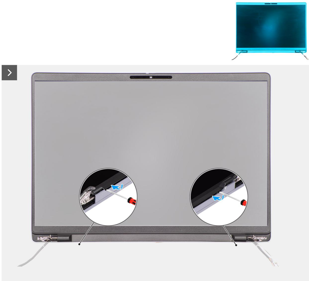
Figura 56. Rimozione della cornice del display
