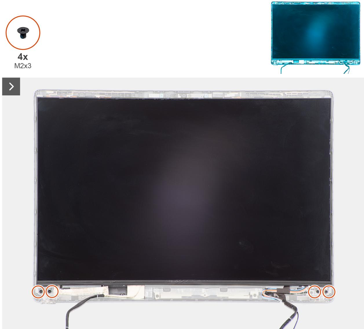
**Figura 64. Rimozione del pannello del display**
