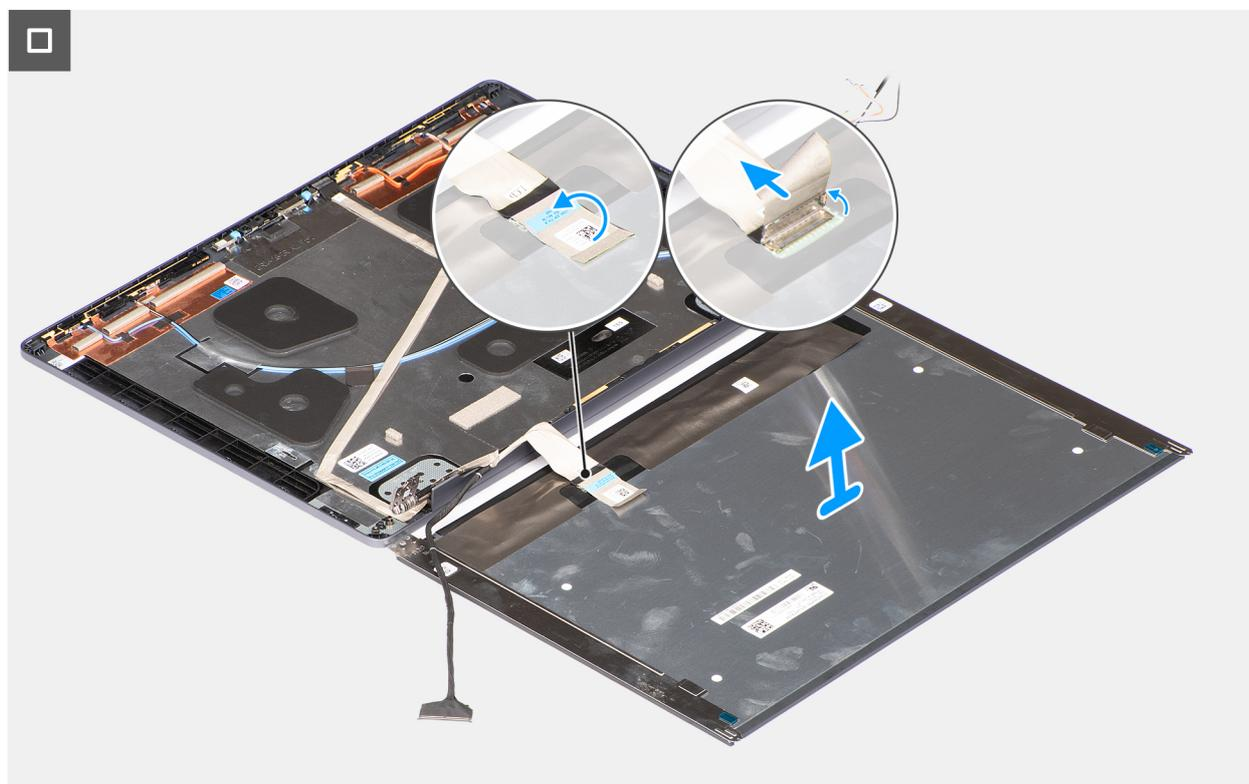
Figura 66. Rimozione del pannello del display
