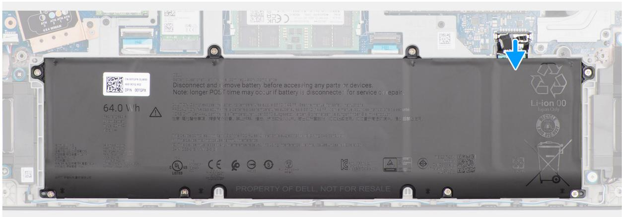
**Figura 14. Rimozione del cavo della batteria**
