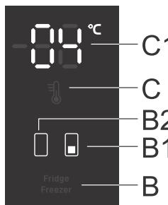
In questo modello, è possibile passare dall'impostazione della temperatura del frigorifero a quella del vano congelatore e viceversa. Basta premere il tasto **B**. Si accende il simbolo del vano desiderato: **B1** per il vano congelatore e **B2** per il vano frigorifero.
