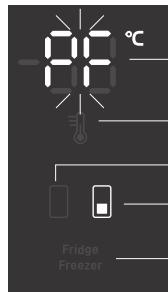
Se l'elettrodomestico si riscalda a una temperatura di allarme durante l'interruzione di corrente, l'allarme di alta temperatura si riattiva al ritorno della corrente elettrica. Verrà emesso un allarme acustico e **PF** lampeggerà sul display **C1**.
