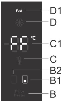
**Per attivare:** premere il tasto **D** per attivare la funzione di congelamento intensivo (super freeze). Si sentirà un segnale acustico e gli indicatori **B1** e **D1** si accenderanno. **FF** verrà visualizzato sul display **C1**. **FF** si accenderà finché la funzione è attiva se il display **B1** è selezionato con il tasto **B**.
