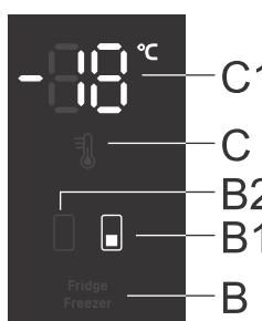
La temperatura nel **vano congelatore** può essere impostata quando il simbolo **B1** è illuminato. Impostare la temperatura premendo brevemente il tasto **C**.
