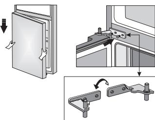
Posizionare lo sportello inferiore sul cardine inferiore e tenerla ferma. Ruotare il cardine centrale di 180°, posizionarvi la rondella e sistemare il cardine nella posizione corretta in modo da poter fissare lo sportello inferiore al suo posto.
