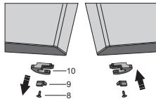
Posizionare lo sportello inferiore su una superficie liscia. Rimuovere la vite (8) e rimuovere il blocco a scatto dello sportello (10) e il fermo dello sportello (9). Quindi, con la vite (8) sul lato opposto dello sportello, fissare il blocco a scatto allegato nella busta e il fermo dello sportello (9). Conservare il blocco a scatto dello sportello (10) per un eventuale uso successivo.
