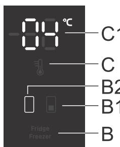
La temperatura nel **vano frigorifero** può essere impostata quando il simbolo **B2** è illuminato. Impostare la temperatura premendo brevemente il tasto **C**.
