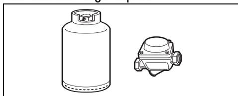
Utilizzare un regolatore di pressione e realizzare il collegamento sulla bombola nel rispetto delle prescrizioni stabilite dalle norme vigenti.
