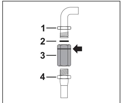
Applicare del materiale isolante sul filetto del tubo gas 4 ed avitarvi l'adattatore 3. Avitare il blocco al raccordo mobile 1 dell'apparecchio interponendo sempre la guarnizione 2 in dotazione.
