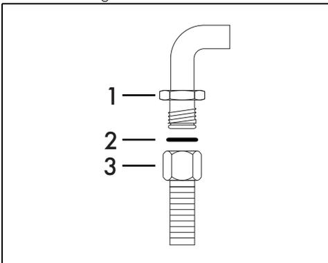
Avitare accuratamente il raccordo 3 al raccordo gas 1 dell'apparecchio interponendo sempre la guarnizione 2 in dotazione.
