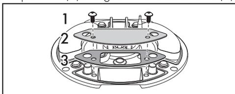
3. Sostituire l'ugello con una chiave da 7 mm secondo il gas da impiegare.
