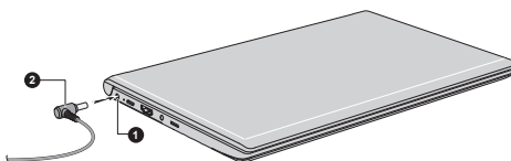
Figura 2-3 Collegamento del connettore di uscita CC al computer
