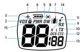
Il vostro ricetrasmettitore utilizza un display LCD (a cristalli liquidi) per informarvi costantemente del suo stato operativo. I simboli ed i parametri che possono apparire di volta in volta sono i seguenti:
