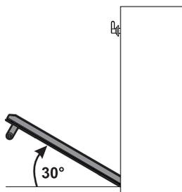
3. Per rimontare la porta inserire le cerniere nelle apposite fessure poste sul forno assicurandosi che le scanalature **A** si appoggino completamente alle fessure. Abbassare la porta verso il basso e una volta posizionata rimuovere i pernetti dai fori delle cerniere.
