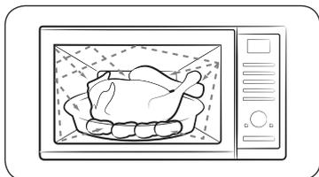
1. Le microonde generate dal magnetron vengono riflesse all'interno della cavità del forno e distribuite uniformemente, man mano che gli alimenti ruotano sul piatto girevole. Ciò permette di cuocere gli alimenti in modo uniforme.
