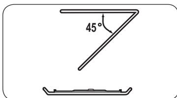
Per la pulizia dell'area superiore del vano cottura, abbassare l'elemento riscaldante superiore di 45° come mostrato. Ciò consentirà di pulire l'area superiore in modo più agevole. Al termine, riposizionare l'elemento riscaldante superiore.
