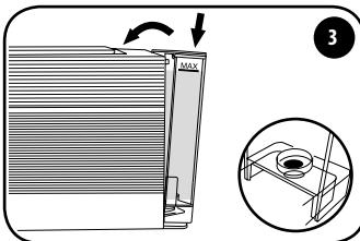
Inserire il serbatoio inclinandolo leggermente e appoggiandolo sulla valvola dell'acqua.
