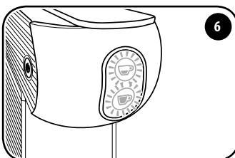
I tasti ☕ e ☕ lampeggiano ad intermittenza, quando si illuminano in modo fisso la macchina ha raggiunto la corretta temperatura ed è pronta per l'utilizzo.
