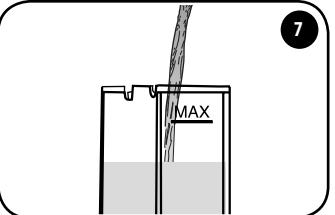
Rimuovere il serbatoio, sciacquarlo e riempirlo con acqua fresca. Reinserire il serbatoio con acqua fresca nella macchina.
