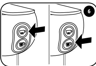
Per l'erogazione di un caffè espresso premere il tasto ☕. Per l'erogazione di un caffè lungo premere il tasto ☕. In caso di difficoltà di chiusura, riaprire la leva e richiudere.
