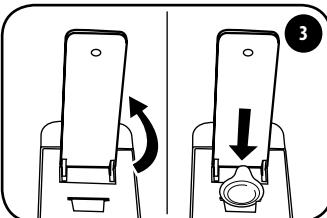
Sollevare la leva e inserire la cialda E.S.E. illy nell'apposita fessura con il logo rivolto verso la leva. Accertarsi che l'intera cialda, ad eccezione della linguetta, sia inserita all'interno della fessura.
