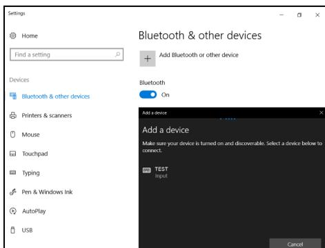
5. Al termine dell'associazione, se sullo schermo viene visualizzato un codice, inserire il codice sul dispositivo per continuare con la connessione.
