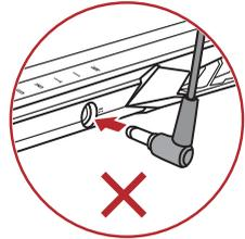
**Nota:** Premere l'adattatore CA nel tunnel sul connettore di alimentazione. Sarà emesso un clic per indicare il collegamento. Verificare quindi che l'indicatore della batteria sia di colore ambra durante la carica.
