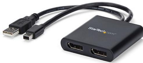
L'hub MST consente di collegare due monitor DisplayPort a un computer dotato di Mini DisplayPort. MST funziona su qualsiasi dispositivo Windows® in grado di supportare DisplayPort 1.2, come i modelli del Think Pad® Lenovo™ e di Microsoft® Surface™. Quando è collegato a versioni precedenti di DisplayPort, quali DP 1.1, l'hub MST funziona da splitter video. L'hub MST viene alimentato dal computer via USB e non richiede alcun alimentatore esterno.
