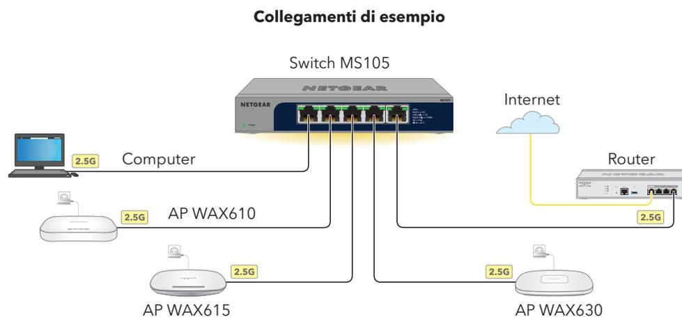
**NOTA:** ogni dispositivo collegato richiede un adattatore di alimentazione poiché lo switch MS105 non fornisce alimentazione PoE.
