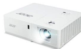
Acer PL6510. Luminosità proiettore: 5500 ANSI lumen, Tecnologia di proiezione: DLP, Risoluzione nativa del proiettore: 1080p (1920x1080). Tipo di sorgente luminosa: Ibrido Laser/LED, Durata della sorgente luminosa: 20000 h. Lunghezza focale: 20.91 - 32.63 mm, Range di apertura (F-F): 2,5 - 3,26, Rapporto di Zoom: 1.6:1. Tipo interfaccia seriale: RS-232. Emissione acustica: 31 dB, Emissione acustica (modalità economica): 28 dB, Modalità di proiezione: Soffitto, Frontale, Posteriore
