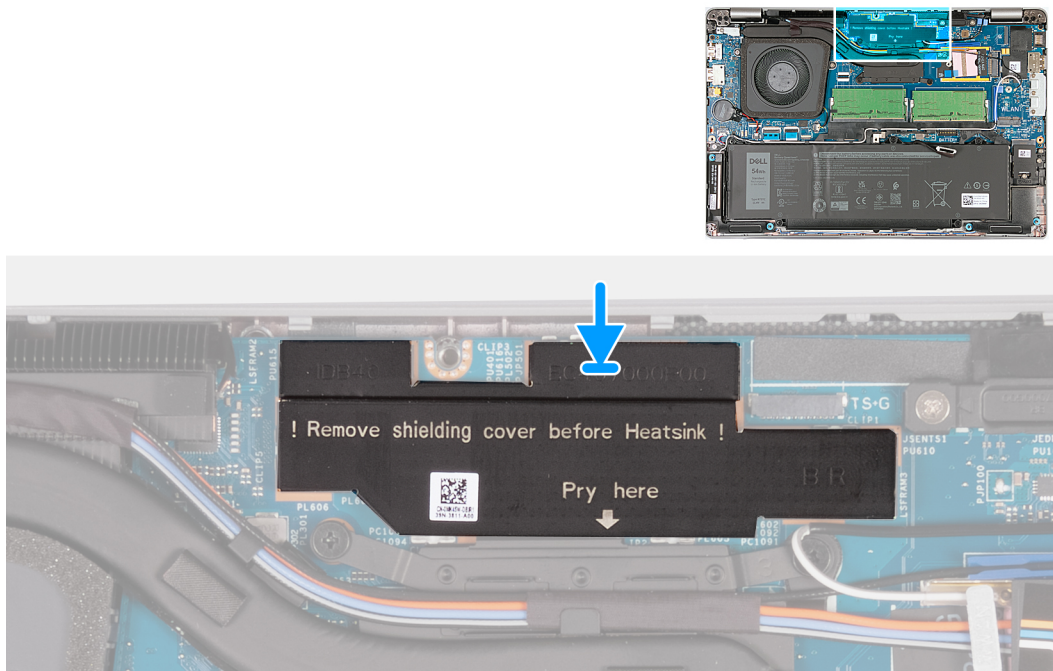
Figura 35. Installazione del coperchio di protezione dell'alimentazione - Per computer forniti con scheda di sistema UMA H28
