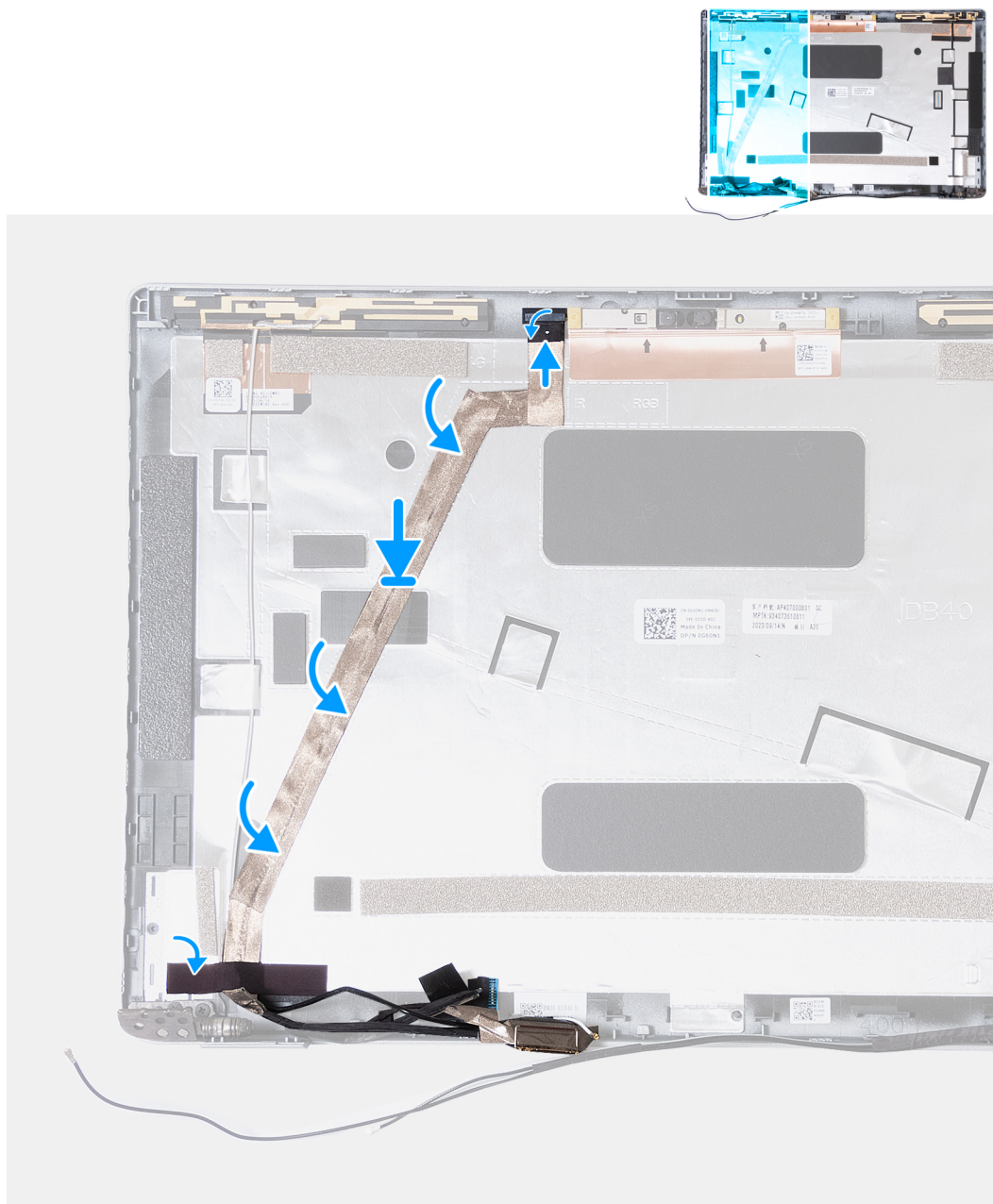
Figura 63. Installazione del cavo del display
