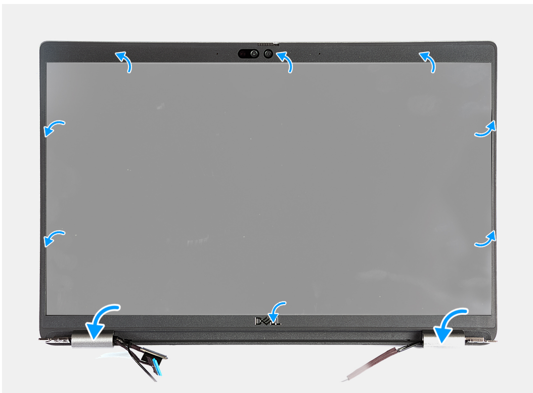
Figura 54. Installazione della cornice del display
