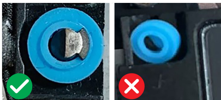
Figura 40. Posizione di seduta dei gommini antivibranti
