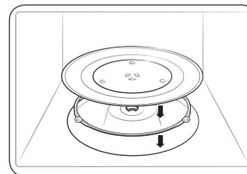
Rimuovere tutti i materiali di imballaggio all'interno del forno a microonde. Installare l'anello e il piatto girevole. Controllare che il piatto girevole ruoti liberamente.
