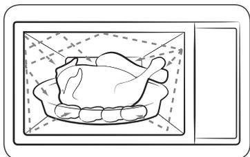
1. Le microonde generate dal magnetron vengono riflesse all'interno della cavità del forno e distribuite uniformemente, man mano che gli alimenti ruotano sul piatto girevole. Ciò permette di cuocere gli alimenti in modo uniforme.
