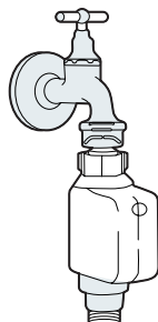
tubo di alimentazione di sicurezza
