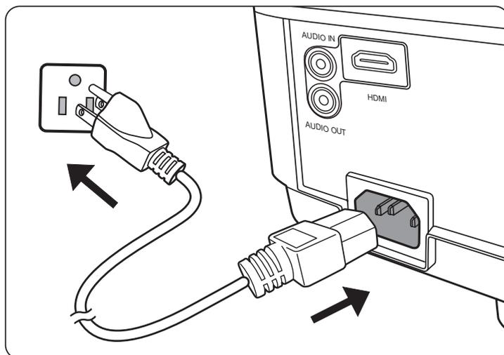
**NOTA:** Quando si installa il proiettore è necessario incorporare un dispositivo di disconnessione facilmente accessibile nel cablaggio elettrico fisso, oppure collegare la spina di alimentazione a una presa di corrente in prossimità dell'unità, accessibile senza difficoltà. In caso di guasto durante l'uso del proiettore, utilizzare il dispositivo di disconnessione per disattivare l'alimentazione, oppure scollegare la spina di alimentazione dalla presa di corrente.
