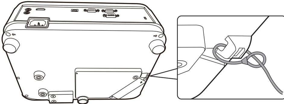
**NOTA:** Lo slot di sicurezza può anche essere usato come ancoraggio di sicurezza se il proiettore è installato a soffitto.
