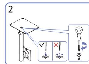
Ruotare completamente la vite di collegamento posta sul fondo del piedistallo in modo da fissarlo saldamente. Fissare la vite grande al centro per il montaggio.
