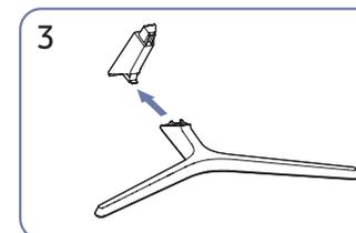
3 Rimuovere il collo del supporto dalla base del supporto tirandolo nella direzione della freccia, come mostrato in figura.
