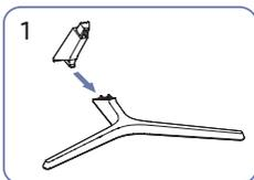
Inserire il collo del supporto nella base del supporto nella direzione indicata nella figura. Verificare che il collo del supporto sia saldamente collegato.
