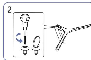
2 Ruotare la vite di collegamento nella parte inferiore della base dello stativo per separarla.
