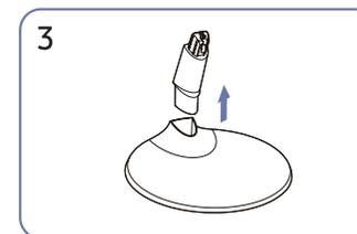
Rimuovere il collo del supporto dalla base del supporto tirandolo nella direzione della freccia, come mostrato in figura.
