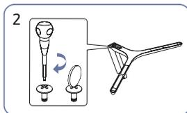
Serrare le vite di collegamento nella parte inferiore della base del supporto.
