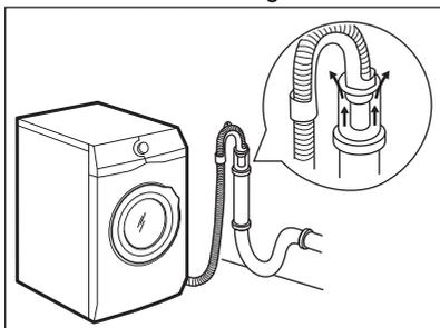
**i** L'estremità del tubo di scarico deve essere sempre ventilata, perciò il diametro interno del condotto di scarico (min. 38 mm = min. 1,5") deve essere più grande del diametro esterno del tubo di scarico.
