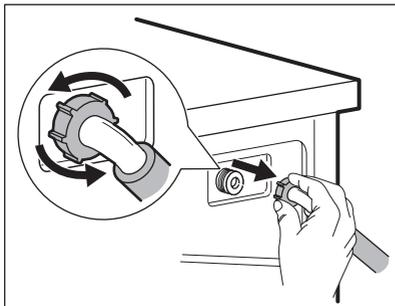
3. Pulire il filtro valvola sul retro dell'apparecchiatura con una spazzola.
